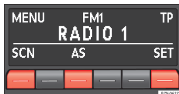
Obr. 10 MENU dodatečných funkcí v režimu autorádia: Automatické vyhledávání vysílačů (rozhlisových stanic) (SCN), automatické ukládání Autostore (AS) a nastavení (SET).
