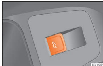
Obr. 126 Ve dveřích řidiče: tlačítko pro otevírání a zavírání zadního víka.
