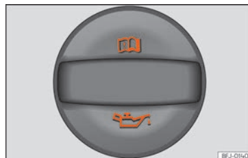
Obr. 60 Víko otvoru pro plnění motorového oleje
