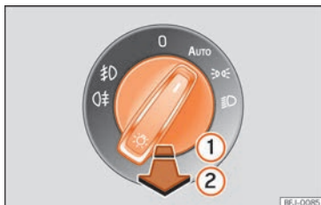
Obr. 132 Přístrojová deska: Ovládací prvek světel
