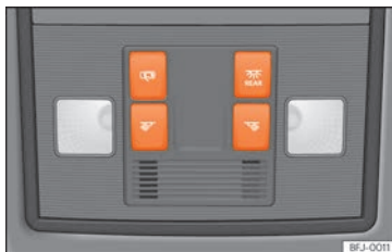
Obr. 46 Detail stropního panelu: Osvětlení interiéru vpředu.
