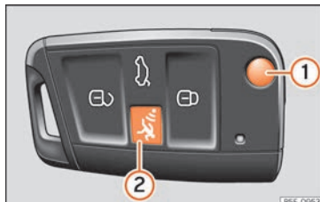
Obr. 118 Klíč od vozidla s tlačítkem alarmu.
