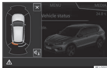
Obr. 287 Miniaturní signalizace automatického zapnutí
