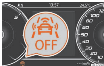
Obr. 260 Na displeji panelu přístrojů: informace o vypnutí systému Front Assist.
