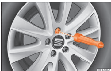
Obr. 78 Kolo: vyšroubujte šrouby kol rukojetí šroubováku.
