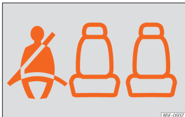
Obr. 88 Panel přístrojů: Zobrazení, že místo vzadu vlevo je obsazeno a spolucestující má připnutý bezpečnostní pás.
