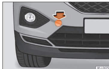
Obr. 98 Na pravé straně předního nárazníku: odstraňte kryt.
