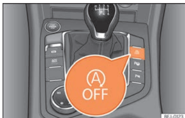
Obr. 250 Středová konzole: Tlačítko systému start-stop.
