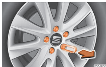
Obr. 73 Kolo: Šrouby kola s víkem.
