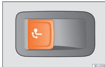
Obr. 297 Na levé straně v zavazadlovém prostoru: tlačítko pro odblokování kulové hlavy.
