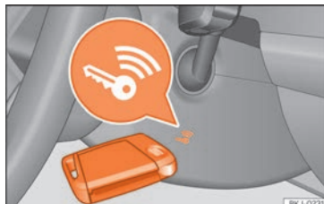
Obr. 244 Vpravo na sloupku řízení: Nouzový start.
