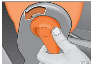
Obr. 149 Odjištění sklápěcího opěradla sedadla spolujezdce
