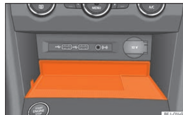
Obr. 242 Ve středové konzole: Úchyt pro spojení mobilního telefonu.
