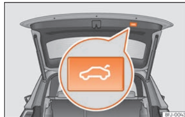
Obr. 125 Zadní víko otevřeno: tlačítko pro okamžité zavření zadního víka.
