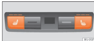
Obr. 189 Ve středové konzole vzadu: Ovládací prvky vyhřívání zadních sedadel.
