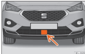
Obr. 264 V předním nárazníku: radarový snímač.
