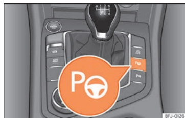
Obr. 279 Ve středové konzole nahoře: Tlačítka pro parkovací asistenta.
