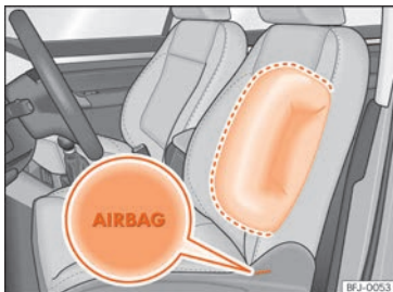
Obr. 32 Boční airbag v sedadle řidiče
