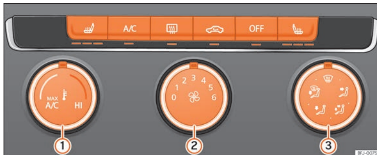
Obr. 58 Ve středové konzole: Ovládací prvky manuální klimatizace.
