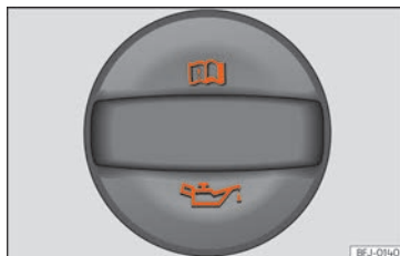
Obr. 305 Víko otvoru pro plnění motorového oleje
