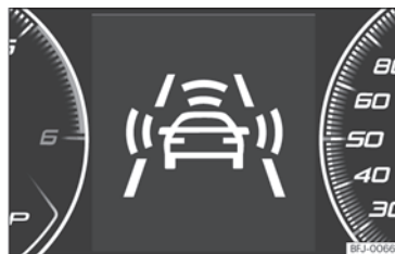
Obr. 258 Na displeji panelu přístrojů: pokyny předběžné výstrahy.
