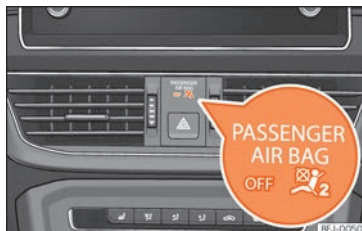
Obr. 29 Přístrojová deska: Kontrolka deaktivovaného airbagu spolujezdce.
