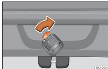
Obr. 11 Detail zavazadlového prostoru: nouzové odemykání.
