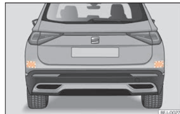
Obr. 274 Oblast za vozidlem: Oblasti radarových snímačů.
