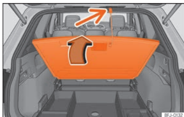
Obr. 159 V zavazadlovém prostoru: Variabilní podlaha zavazadlového prostoru zvednuta.
