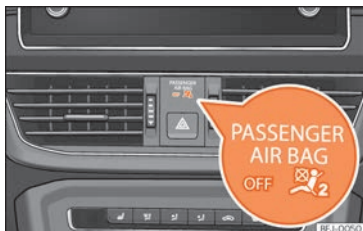
Obr. 96 Přístrojová deska: Kontrolka deaktivovaného airbagu spolujezdce.
