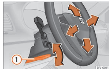
Obr. 24 Páčka na levé spodní straně sloupku řízení.
