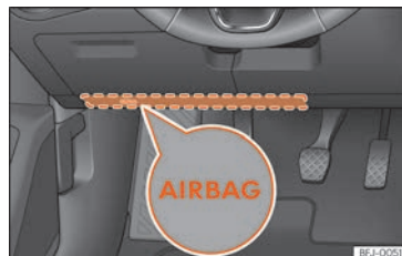
Obr. 30 Na straně řidiče: umístění kolenního airbagu.
