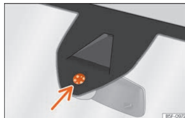
Obr. 138 Citlivá plocha dešťového snímače.
