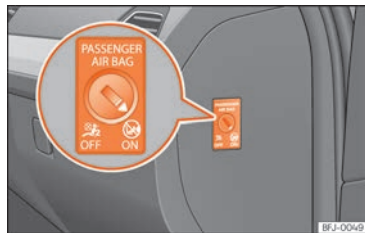
Obr. 28 Spínač čelního airbagu spolujezdce.
