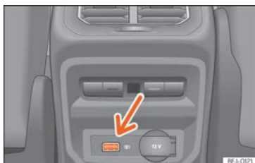
Obr. 240 Středová konzola vzadu: Konektory USB.
