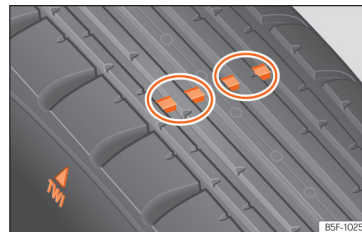
Obr. 320 Vzorok pneumatiky: ukazatele opotřebení.
