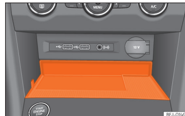
Obr. 239 Ve středové konzole: Úchyt pro sprášení mobilního telefonu.
