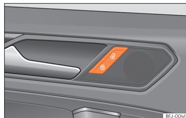
Obr. 76 Dveře řidiče: tlačítko centrálního zamykání dveří.
