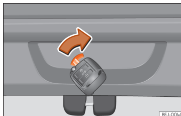
Obr. 88 Detail zavazadlového prostoru: nouzové odemknutí.
