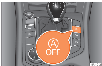
Obr. 243 Středová konzola: Tlačítko systému Start-Stop.
