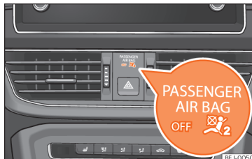
Obr. 19 Přístrojová deska: kontrolka odpojení airbagu spolujezdce.
