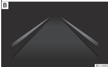
Obr. 271 Na displeji panelu přístrojů: Zobrazení na displeji asistenta udržování jízdního pruhu (příklad 1).
