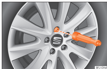
Obr. 42 Výměna kola: vyšroubujte šrouby kol rukojetí šroubováku.
