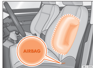
Obr. 22 Boční airbag v sedadle řidiče
