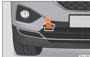
Obr. 48 Na pravé straně předního nárazníku: odstranění krytu.
