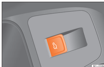
Obr. 86 U dveří řidiče: tlačítko pro otvírání a zavírání zadního víka.
