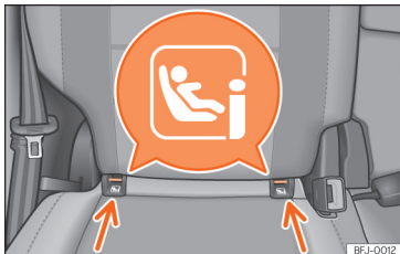
Obr. 28 Vnější sedadla v druhé řadě: Přídržná oka ISOFIX/i-Size.
