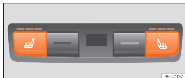
Obr. 158 Ve středové konzole vzadu: Ovládací prvky vyhřívání zadních sedadel.
