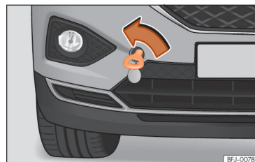
Obr. 49 Na pravé straně předního nárazníku: zašroubované vlečné oko.
