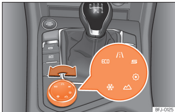
Obr. 249 Středová konzola: otočné tlačítko [Driving Experience button].
