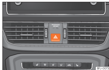
Obr. 98 Přístrojová deska: spínač výstražných světel.
