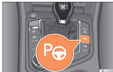
Obr. 281 V horní části středové konzoly: tlačítko pro zapnutí parkovacího asistenta.
