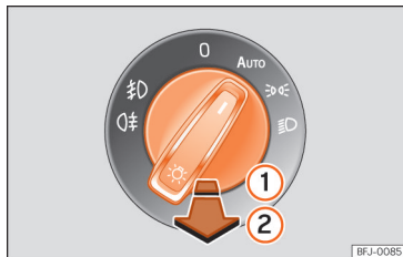
Obr. 95 Přístrojová deska: spínač světel.
