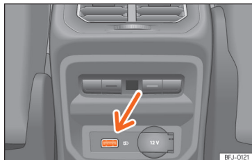
Obr. 237 Středová konzola vzadu: Konektory USB.
