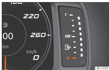
Obr. 62 Volně konfigurovatelný panel přístrojů: palivoměr
