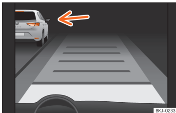
Obr. 267 Na displeji panelu přístrojů: ACC aktivní, identifikováno vozidlo na levé straně
