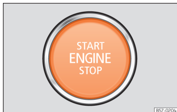
Obr. 240 Ve spodní části středové konzoly: Startovací tlačítko.
