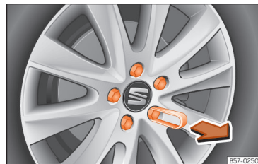
Obr. 36 Kola: Šrouby kola s víkem.
