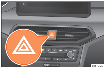
Obr. 95 Přístrojová deska: spínač výstražných světel.
