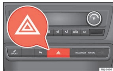
Obr. 31 Přístrojová deska: Spínač varovných světel
