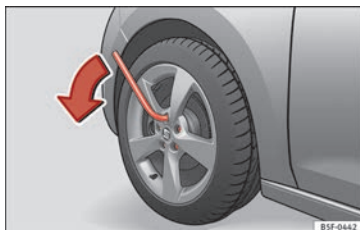
Obr. 64 Kolo: povolte šrouby kol.
