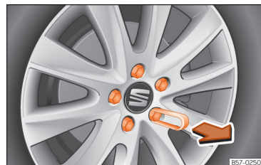
Obr. 187 Kolo: šrouby kola s víkem.
