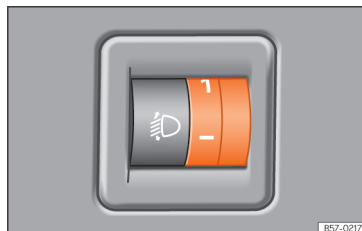
Obr. 75 Vedle volantu: ovladač regulace dosahu světel
