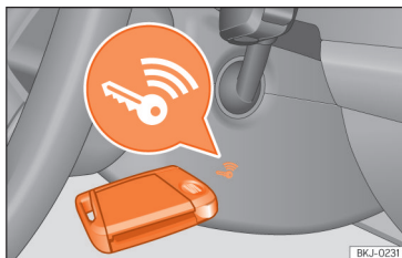
Obr. 87 Vpravo na sloupku řízení: nouzový start.
