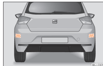
Obr. 100 Oblast za vozidlem: oblasti radarových snímačů.
