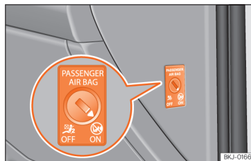
Obr. 30 Klíčem ovládaný spínač pro připojení a odpojení airbagu spolujezdce.
