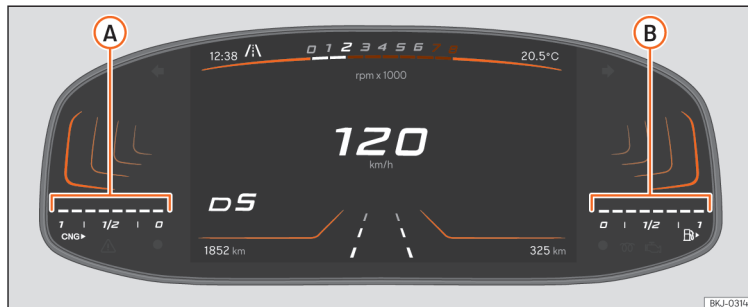
Obr. 7 Panel přístrojů: ukazatel zásoby zemního plynu
