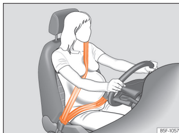
Obr. 27 Vedení popruhu pásu u těhotných žen
