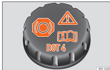
Obr. 174 Motorový prostor: uzávěr nádrčky brzdové kapaliny
