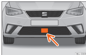
Obr. 97 V předním nárazníku: radarový snímač.
