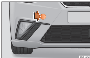
Obr. 156 Na pravé straně předního nárazníku: odstranění krytu.
