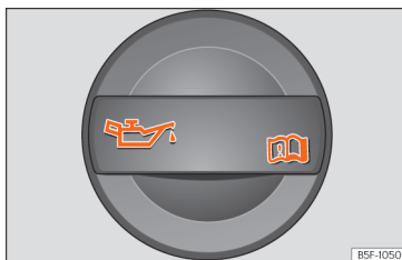
Obr. 179 Uzávěr plnicího otvoru motorového oleje v motorovém prostoru.
