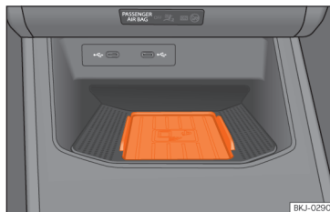
Obr. 136 Ve středové konzole: úchyt pro spřáhnutí mobilního telefonu.
