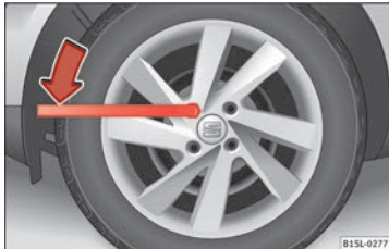
Obr. 53 Výměna kola: povolte šrouby kol.
