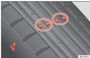
Obr. 174 Vzorek pneumatiky: ukazatele opotřebení.
