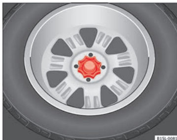
Obr. 176 V zavazadlovém prostoru: Ruční kolečko pro upevnění rezervního kola.
