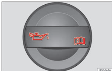
Obr. 168 V motorovém prostoru: víko plnicího otvoru motorového oleje.
