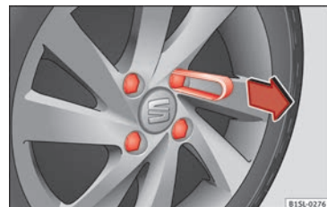
Obr. 52 Stáhnutí krytek ze šroubů kola
