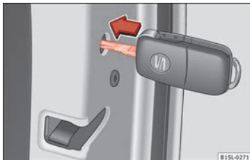
Obr. 5 Nouzové zamykání vozidla klíčem vozidla.
