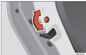
Obr. 105 Bezpečnostní dětská pojistka v levých dveřích
