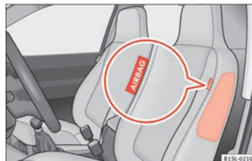
Obr. 21 Na straně předního sedadla: umístění bočního airbagu.
