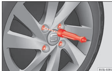
Obr. 57 Výměna kola: našroubování šroubů kol rukojetí šroubováku.
