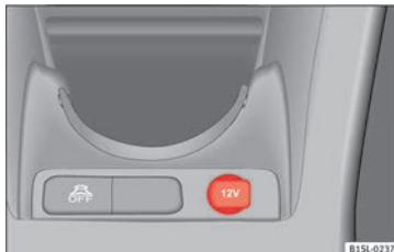
Obr. 131 Středová konzole vpředu: 12 V zásuvka v odkládací přihrádce.
