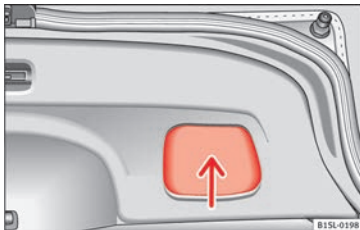
Obr. 107 Otevřené zadní výklopné dveře (zadní víko): zapuštěné madlo pro zavírání zavazadlového prostoru
