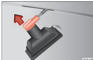
Obr. 91 Světlo registrační značky: Demontáž nosiče žárovky.
