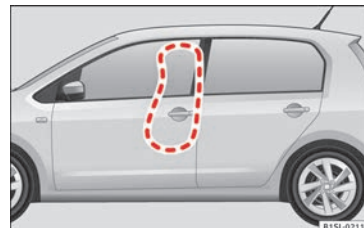
Obr. 22 Na levé straně vozidla: oblast rozvinutí bočního airbagu.
