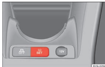
Obr. 175 Středová konzole: Tlačítko ukazatele kontroly tlaku vzduchu v pneumatikách
