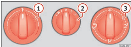
Obr. 139 Na středové konzole: Otočný ovladač systému vytápěcího a čerstvého vzduchu.
