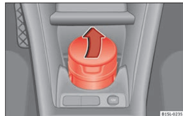
Obr. 129 Ve středové konzole vpředu: Otevření popelníku.
