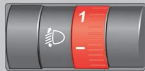
Obr. 111 Vedle volantu: Ovladač regulace sklonu světlometů.
