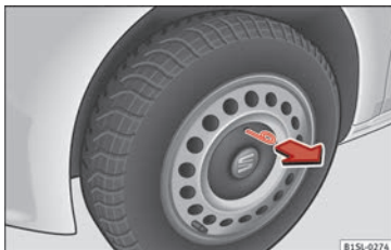
Obr. 50 Stáhněte středový kryt z ocelového disku.
