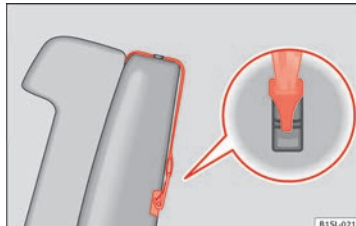
Obr. 27 Příklad zavěšeného horního upevňovacího popruhu.
