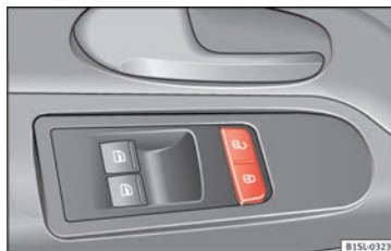
Obr. 103 U dveří řidiče: tlačítko centrálního zamykání dveří.
