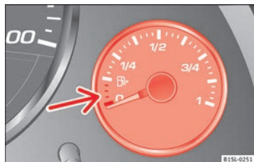
Obr. 163 Panel přístrojů: palivoměr pro benzin.
