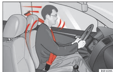
Obr. 69 Řidiči se správně připnutými pásy nebudou při náhlém brzdění vymrštěni dopředu.
