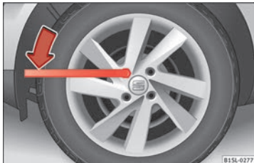
Obr. 53 Výměna kola: povolte šrouby kol.
