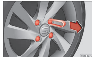
Obr. 52 Stáhnutí krytek ze šroubů kola
