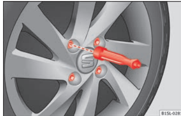
Obr. 57 Výměna kola: našroubování šroubů kol rukojetí šroubováku.
