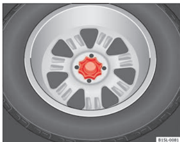
Obr. 177 V zavazadlovém prostoru: Ruční kolečko pro upevnění rezervního kola.
