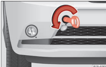
Obr. 58 Přední nárazník vpravo: zašroubované vlečné oko
