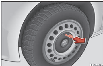
Obr. 50 Stáhněte středový kryt z ocelového disku.
