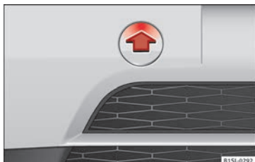
Obr. 80 Přední nárazník vpravo: Sejměte kryt.
