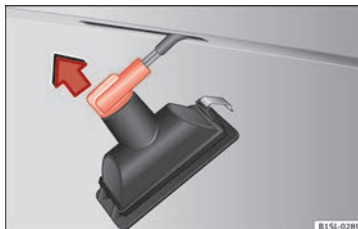
Obr. 91 Světlo registrační značky: Demontáž nosiče žárovky.
