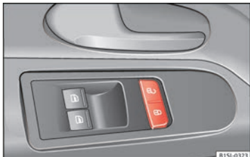
Obr. 2 U dveří řidiče: tlačítka centrálního zamykání dveří.
