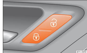
Obr. 90 Dveře řidiče: tlačítko centrálního zamykání dveří.
