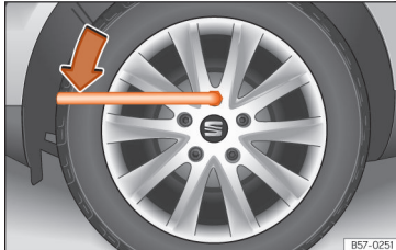
Obr. 45 Výměna kola: povolení šroubů kola.
