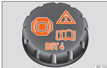
Obr. 292 Motorový prostor: uzávěr nádoby brzdové kapaliny.
