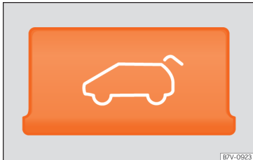
Obr. 102 Ve středové konzole: Odjišťovací tlačítko zadního víka.
