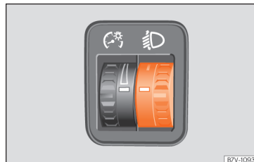
Obr. 118 Vedle volantu: Ovladač regulace dosahu světel.
