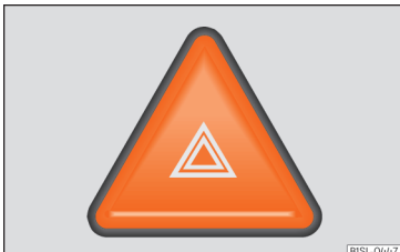
Obr. 117 Přístrojová deska: spínač výstražných světel.
