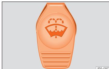
Obr. 293 V motorovém prostoru: uzávěr nádržky kapalinu do ostříkovačů.
