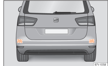
Obr. 260 Pohled na zad' vozidla: Oblasti radarových snímačů.
