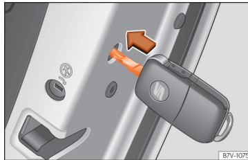
Obr. 97 Nouzové zamykání vozidla klíčem vozidla.
