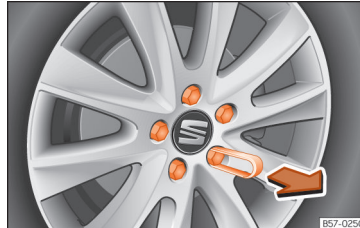
Obr. 43 Kolo: Šrouby kola s víkem.
