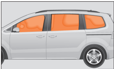
Obr. 25 Nafouknuté hlavové airbagy.
