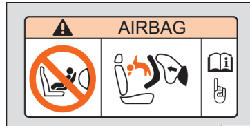
Obr. 27 Nálepka pro airbag: na sluneční cloně na straně spolujezdce
