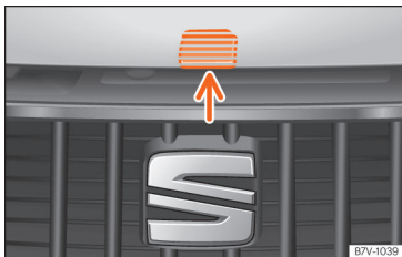
Obr. 286 Páčka pod víkem motorového prostoru.
