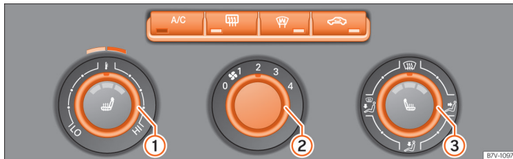
Obr. 174 Ve středové konzole: ovládací prvky klimatizace.
