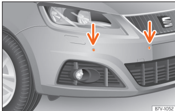
Obr. 271 Snímače kontroly parkovací vzdálenosti vpředu v nárazníku.
