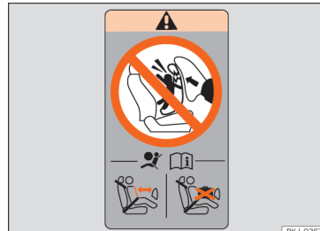
Obr. 28 Nálepka pro airbag: v zadní části rámu dveří spolujezdce
