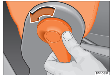
Obr. 139 Odjištění sklápěcího opěradla sedadla spolujezdce
