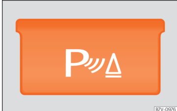
Obr. 270 Ve středové konzole: Tlačítko zapínání a vypínání parkovacího asistenta.
