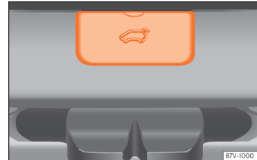
Obr. 107 Detail zavazadlového prostoru: přístup k nouzovému odemykání.
