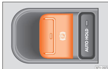
Obř. 264 Ve středové konzole: tlačítko elektronické parkovací brzdy.
