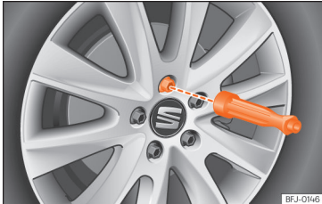
Obr. 49 Výměna kola: vyšroubujte šrouby kol rukojetí šroubováku.
