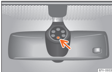
Obr. 122 Citlivá plocha snímače deště.
