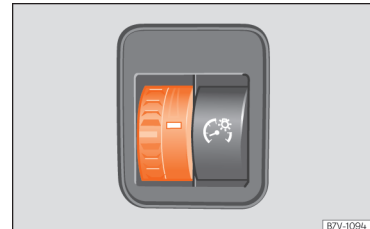
Obr. 119 Vedle volantu: ovladač osvětlení přístrojů a spínačů
