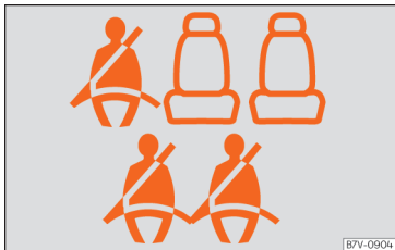
Obr. 6 Příklad zobrazení stavu bezpečnostního pásu pro zadní místa k sezení (zde u 7sedadlového vozidla) v panelu přístrojů: nahoře druhá řada sedadel, dole třetí řada sedadel.
