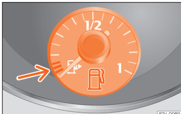
Obr. 78 Panel přístrojů: ukazatel zásoby benzínu nebo motorové nafty.
