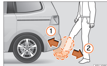
Obr. 106 Zadní víko s otvíráním řízeným snímačem (Easy Open).
