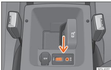
Obr. 231 Středová loketní opěrka vpředu: Přípojka USB/AUX-IN.
