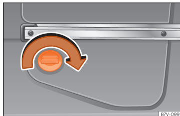
Obr. 284 Nádrž AdBlue s uzávěrem plnicího hrdla a plnicí lahví
