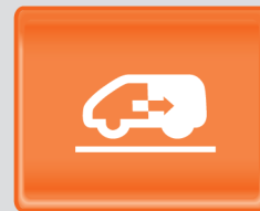
Obr. 99 Na přístrojové desce, v klíči od vozidla nebo na vnitřním krycím panelu před posuvnými dveřmi: tlačítko otvírání a zavírání elektricky ovládaných posuvných dveří
