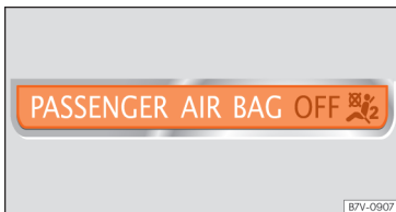
Obr. 19 Kontrolka odpojeného airbagu spolujezdce v přístrojové desce.
