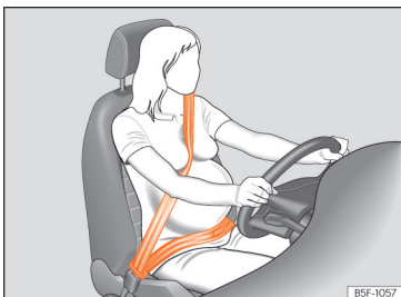
Obr. 13 Průběh popruhu pásu u těhotných žen
