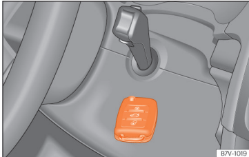
Obr. 235 Nouzové nastartování u vozidel s Keyless Access.
