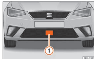
Obr. 237 V předním nárazníku: radarový snímač.
