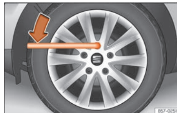
Obr. 74 Výměna kola: Povolení šroubů kol
