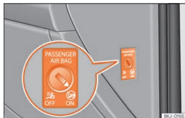
Obr. 25 Spínač čelního airbagu spolujezdce.
