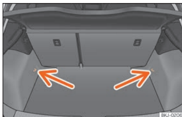
Obr. 165 Uspořádání upevňovacích ok v zavazadlovém prostoru.
