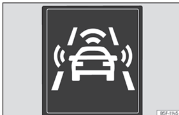
Obr. 231 Na displeji panelu přístrojů: pokyny předběžné výstrahy.
