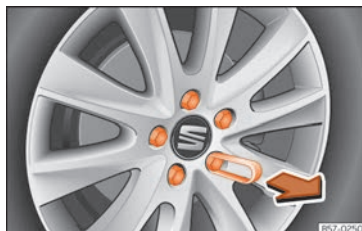
Obr. 73 Kolo: Šrouby kola s víkem.
