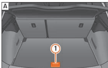
Obr. 167 Variabilní podlaha zavazadlového prostoru: sklopená poloha.
