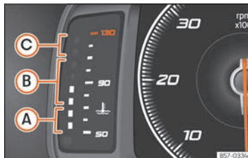
Obr. 124 Volně konfigurovatelný panel přístrojů: ukazatel teploty chladicí kapaliny motoru.
