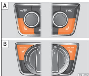
Obr. 151 Ve středové konzole: Ovladač vyhřívání předních sedadel. [A]: verze s Climatronic. [B]: verze s ruční klimatizací.
