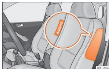
Obr. 27 Boční airbag v sedadle řidiče
