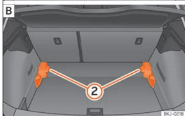
Obr. 166 Variabilní podlaha zavazadlového prostoru: A vysoká poloha; B nízká poloha.
