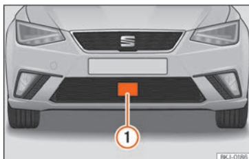
Obr. 232 V předním nárazníku: radarový snímač.
