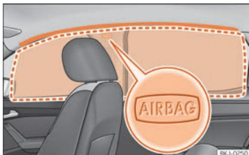
Obr. 29 Umístění a oblast nafouknutí hlavového airbagu.
