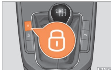
Obr. 5 Středová konzole: tlačítko centrálního zamykání dveří.
