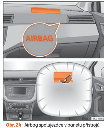
Obr. 24 Airbag spolujezdce v panelu přístrojů
