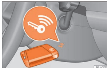
Obr. 218 Vpravo na sloupku řízení: Nouzový start.
