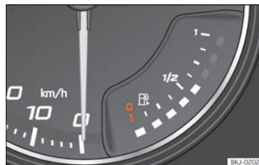
Obr. 120 Analogový panel přístrojů: ukazatel zásoby paliva
