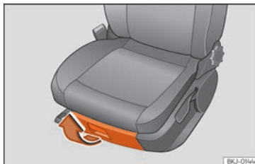
Obr. 156 Odkládací přihrádka pod pravým předním sedadlem.
