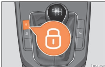
Obr. 134 Tlačítko centrálního zamykání
