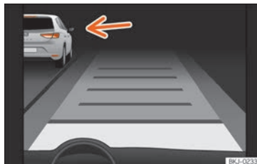
Obr. 240 Na displeji panelu přístrojů: ACC aktivní, identifikováno vozidlo na levé straně
