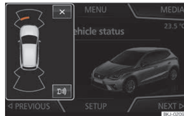
Obr. 246 Miniaturní signalizace automatického zapnutí
