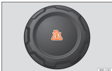
Obr. 209 Přední prostor: uzávěr vyrovnávací nádobky chladicí kapaliny.
