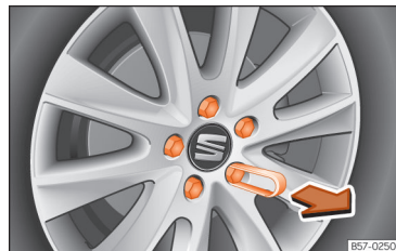
Obr. 222 Kolo: šrouby kola s víkem.
