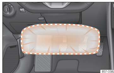
Obr. 32 Na straně řidiče: oblast působnosti kolenního airbagu.
