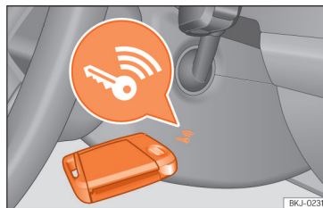
Obr. 95 Vpravo na sloupku řízení: nouzový start.
