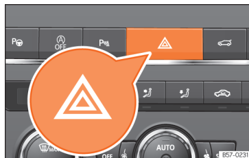
Obr. 41 Přístrojová deska: spínač výstražných světel.
