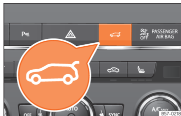
Obr. 58 Středová konzola: tlačítko pro otevírání a zavírání zadního víka.
