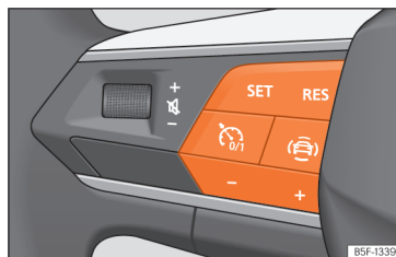
Obr. 111 Na multifunkčním volantu: tlačítka k ovládání tempomatu.
