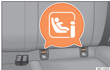
Obr. 36 Zadní sedadlo: Montážní místa přídržných ok pro ISOFIX nebo i-Size.
