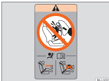
Obr. 35 Štítek airbagu: na horním rámu dveří spolujezdce.
