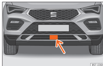
Obr. 105 V předním nárazníku: radarový snímač.
