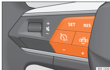
Obr. 112 Na multifunkčním volantu: tlačítka k ovládání omezovače rychlosti.
