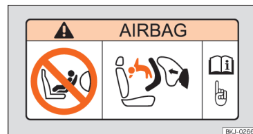
Obr. 34 Štítek airbagu: na sluneční cloně.
