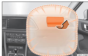
Obr. 25 Airbag spolujezdce v přístrojové desce
