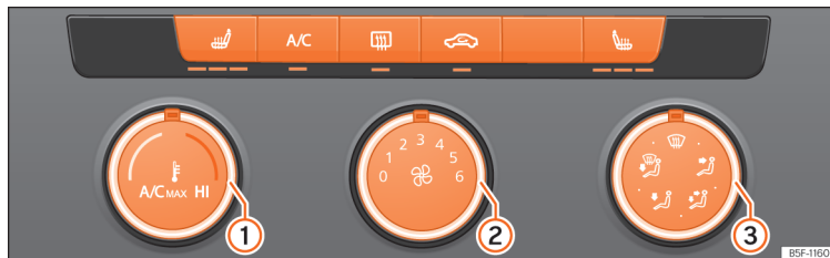
Obr. 90 Ve středové konzole: Ovládací prvky manuální klimatizace.
