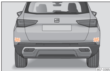
Obr. 108 Oblast za vozidlem: oblasti radarových snímačů.
