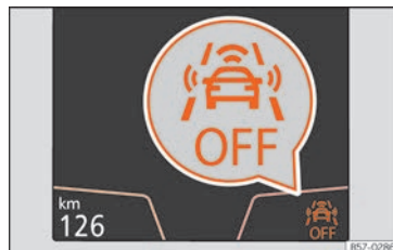
Obr. 233 Na displeji panelu přístrojů: informace o vypnutí systému Front Assist.
