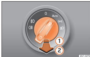
Obr. 143 Přístrojová deska: Ovládací prvek světel
