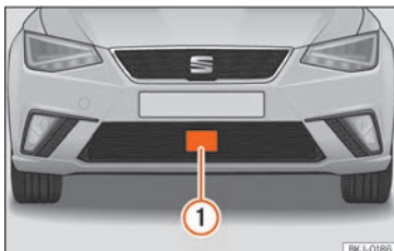
Obr. 232 V předním nárazníku: radarový snímač.
