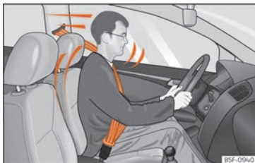
Obr. 91 Řidiči se správně připnutými pásy nebudou při náhlém brzdění vymrštěni dopředu.
