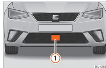
Obr. 237 V předním nárazníku: radarový snímač.
