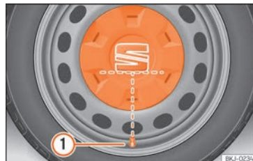
Obr. 71 Správné umístění celoplošného krytu kola u ocelových disků.
