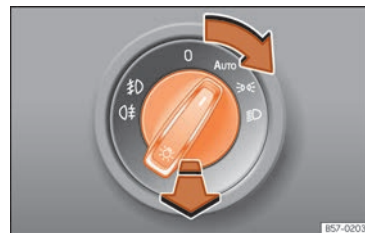
Obr. 42 Přístrojová deska: Ovládací prvek světel
