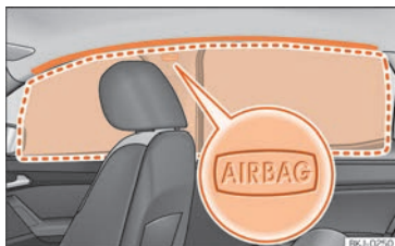
Obr. 29 Umístění a oblast nafouknutí hlavového airbagu.
