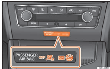
Obr. 26 Střední díl přístrojové desky: Kontrolka při odpojení airbagu spolujezdce.
