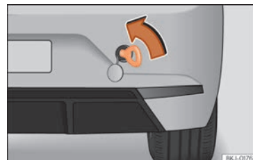
Obr. 102 Zadní nárazník vpravo: zašroubované vlečné oko
