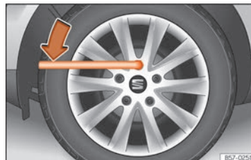
Obr. 74 Výměna kola: Povolení šroubů kol
