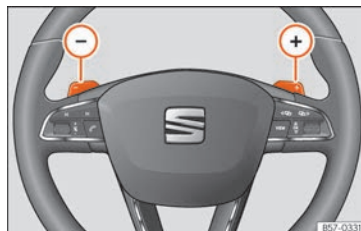
Obr. 223 Volant: páčky pro automatickou převodovku.
