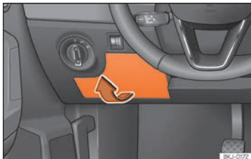
Obr. 64 Na straně řidiče v přístrojové desce: kryt pojistkové skříňky.
