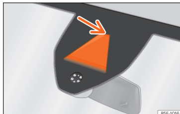
Obr. 269 Na čelním skle: Průzor kamery asistentu udržování jízdního pruhu.
