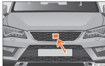
Obr. 257 V přední části za logem SEAT: radarový snímač.
