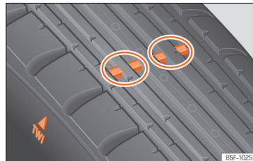
Obr. 318 Vzorek pneumatiky: ukazatele opotřebení.
