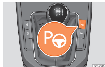
Obz. 122 Ve středové konzole: tlačítko pro zapnutí navigačního parkovacího asistenta.
