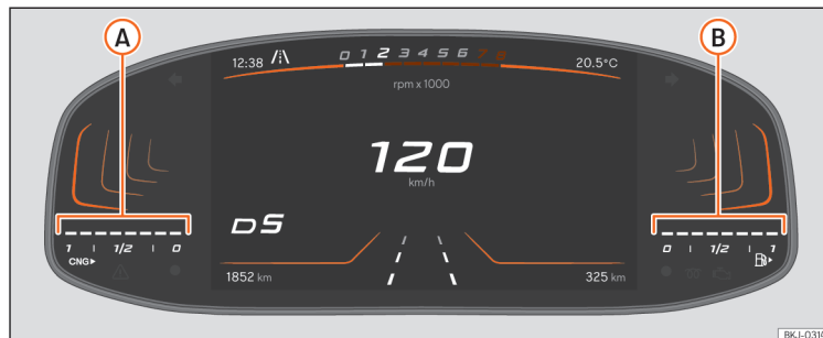
Obr. 7 Panel přístrojů: ukazatel zásoby zemního plynu
