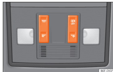
Obř. 74 Výřez stropního panelu: vnitřní osvětlení vpředu.
