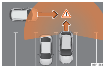
Obr. 129 Schematické vyobrazení asistenta vyparkování: sledovaná oblast vyjíždějícího vozidla.
