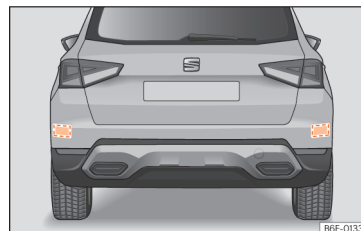
Obr. 97 Oblast za vozidlem: oblasti radarových snímačů.
