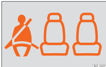
Obr. 21 Panel přístrojů: signalizace stavu bezpečnostních pásů pro zadní sedadla.
