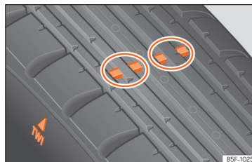
Obr. 189 Vzorok pneumatiky: ukazatele opotřebení.
