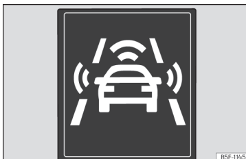
Obr. 107 Na displeji panelu přístrojů: upozornění předběžné výstrahy.
