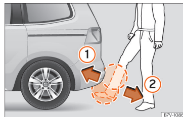
Obr. 106 Zadní víko se snímači řízeným otvíráním a zavíráním (Easy Open).
