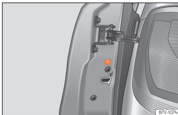
Obr. 96 V přední části posuvných dveří: gumovým těsněním zakryté nouzové zamykání.
