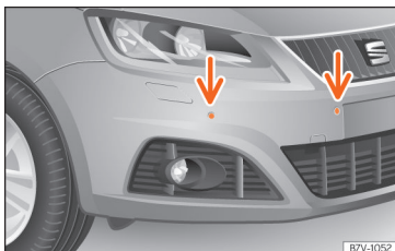
Obr. 272 Senzory kontroly parkovací vzdálenosti vpředu v nárazníku.
