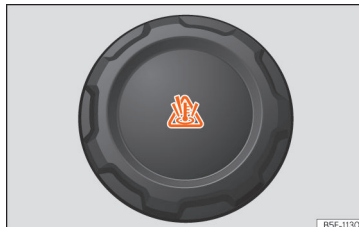
Obr. 293 Motorový prostor: uzávěr vyrovnávací nádobky chladicí kapaliny motoru.
