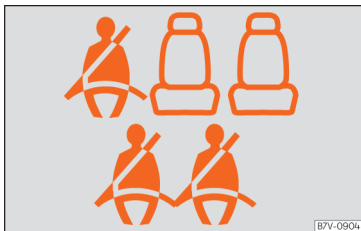
Obr. 6 Příklad zobrazení stavu bezpečnostního pásu pro zadní místa k sezení (zde u 7sedlového vozidla) v panelu přístrojů: nahore druhá řada sedadel, dole třetí řada sedadel.
