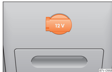
Obr. 171 Středová konzola vzadu: zásuvka 12V.
