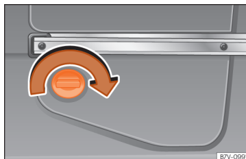
Obr. 283 V zavazadlovém prostoru vzadu vlevo: nádržka pro AdBlue za krytem.
