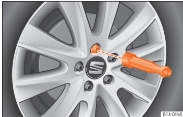
Obr. 49 Výměna kola: vyšroubujte šrouby kol rukojetí šroubováku.
