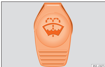
Obr. 295 V motorovém prostoru: uzávěr nádrčky kapaliny do ostřikovačů.
