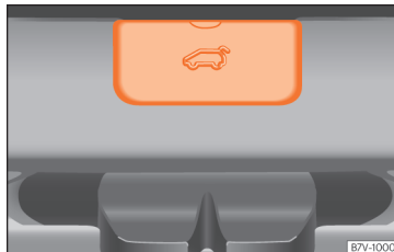
Obr. 107 Detail zavazadlového prostoru: přístup k nouzovému odemykání.
