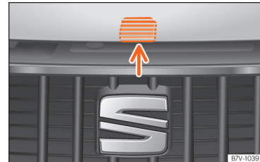
Obr. 286 Páčka pod víkem motorového prostoru.
