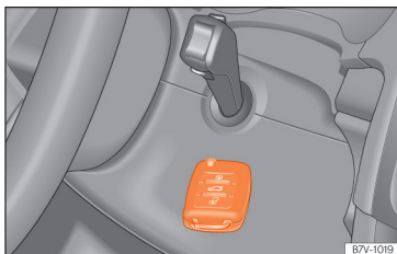
Obr. 235 Nouzové nastartování u vozidel s Keyless Access.
