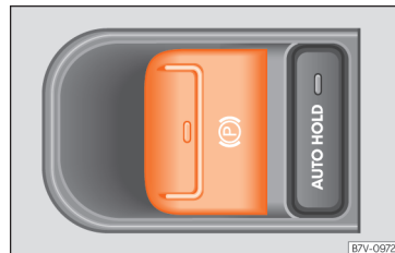
Obr. 266 Ve středové konzole: tlačítko elektronické parkovací brzdy.
