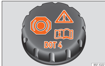
Obr. 294 Motorový prostor: uzávěr nádobky brzdové kapaliny.
