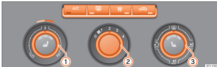
Obr. 174 Ve středové konzole: ovládací prvky klimatizace.
