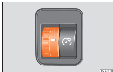
Obr. 119 Vedle volantu: ovladač osvětlení přístrojů a spínačů
