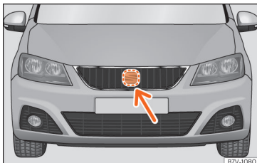
Obr. 244 Na předním nárazníku: radarový snímač.
