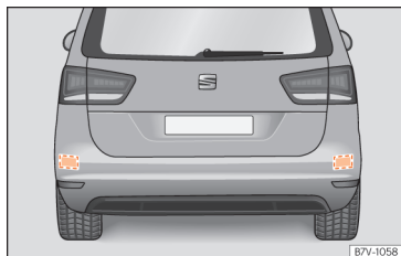
Obr. 247 Pohled na zád vozidla: oblasti radarových snímačů.
