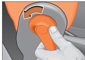
Obr. 139 Odjištění sklápěcího opěradla sedadla spolujezdce
