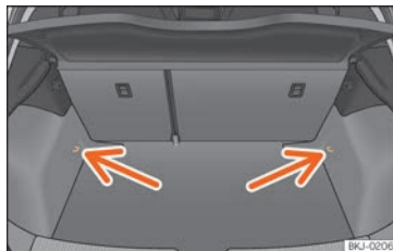
Obr. 143 Uspořádání uvažovacích ok v zavazadlovém prostoru.
