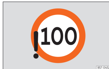
Obr. 11 Na displeji panelu přístrojů: zjištění překročení přípustné maximální rychlosti (vyobrazení).
