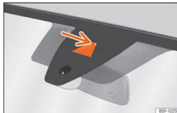
Obr. 98 Oblast výhledu kamery asistenta udržování jízdního pruhu.
