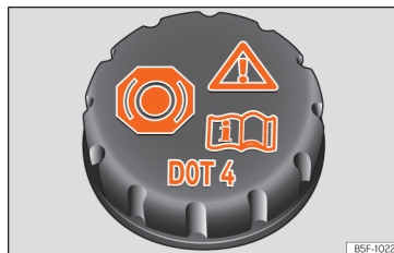
Obr. 207 Motorový prostor: uzávěr nádrží brzdové kapaliny
