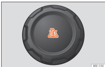
Obr. 206 Přední prostor: uzávěr vyrovnávací nádobky chladicí kapaliny.
