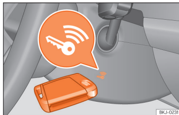
Obr. 98 Vpravo na sloupku řízení: nouzový start.
