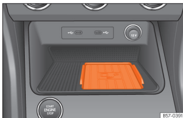
Obr. 164 Ve středové konzole: úchyt pro spřáhnutí mobilního telefonu.
