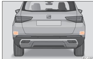
Obr. 111 Oblast za vozidlem: oblast radarových snímačů.
