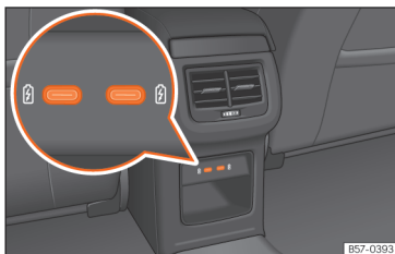
Obr. 157 Středová konzola vzadu: Přípojky USB s funkcí zásuvky.
