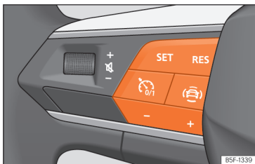
Obr. 114 Na multifunkčním volantu: tlačítka k ovládání tempomatu.
