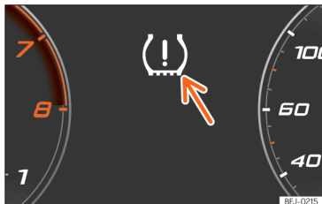
Obr. 226 Panel přístrojů: výstraha pro ztrátu tlaku v pneumatice.
