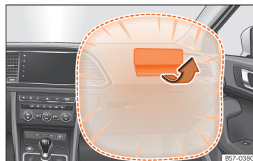
Obr. 28 Airbag spolujezdce v přístrojové desce.
