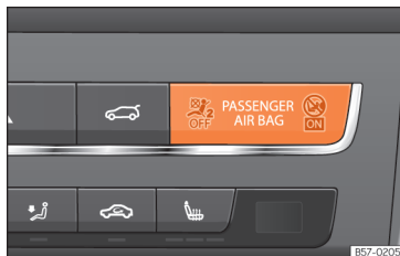
Obr. 30 Přístrojová deska: kontrolka deaktivovaného airbagu spolujezdce.
