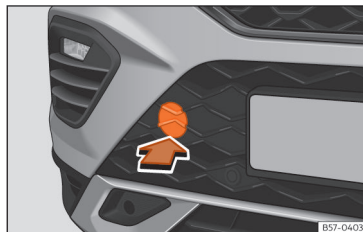
Obr. 193 Na pravé straně předního nárazníku: odstranění krytu.
