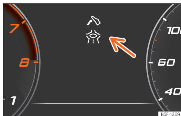
Obr. 11 Signalizace asistenta pro ekologický způsob jízdy (schématické znázornění).
