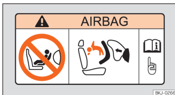
Obr. 37 Štítek airbagu: na sluneční cloně.
