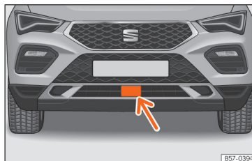
Obr. 108 V předním nárazníku: radarový snímač.
