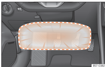
Obr. 35 Na straně řidiče: oblast působnosti kolenního airbagu.
