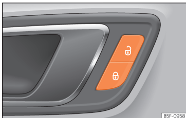
Obr. 54 Ve dveřích řidiče: tlačítko centrálního zamykání.
