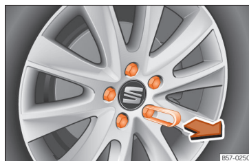
Obr. 220 Kolo: šrouby kola s víkem.
