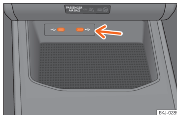
Obr. 131 Středová konzola: vstup USB.
