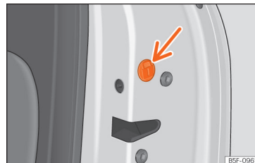
Obr. 88 Nouzová uzávěra dveří.
