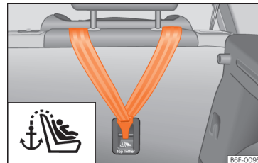
Obr. 27 Zadní strana zadní sedadlové lavice: Přidrzná oka pro pás Top Tether.
