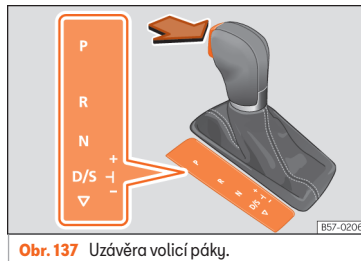
Obr. 137 Uzávěra volicí páky.
