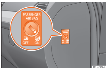
Obr. 20 Klíčem ovládaný spínač pro připojení a odpojení airbagu spolujezdce.
