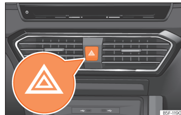
Obr. 103 Přístrojová deska: spínač výstražných světel.
