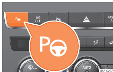
Obr. 138 Ve středové konzole nahoře: Tlačítka pro parkovacího asistenta.
