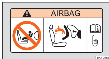
Obr. 34 Štítek airbagu: na sluneční cloně.
