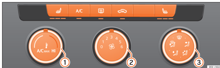
Obr. 90 Ve středové konzole: Ovládací prvky manuální klimatizace.
