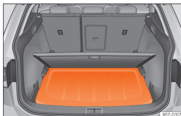
Obr. 170 V zavazadlovém prostoru: vložení krytu zavazadlového prostoru.
