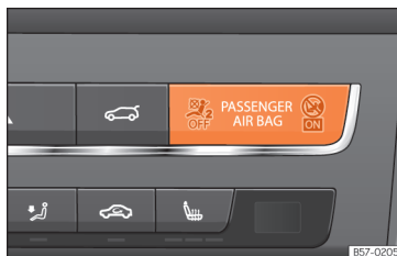
Obr. 27 Přístrojová deska: kontrolka deaktivovaného airbagu spolujezdce.
