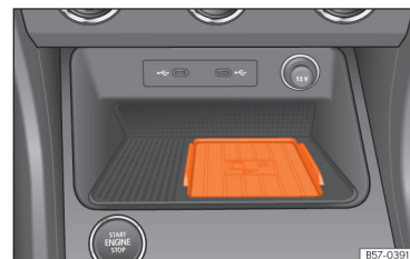
Obr. 166 Ve středové konzole: úchyt pro správnou mobilního telefonu.
