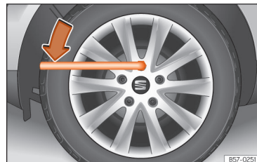
Obr. 226 Výměna kola: povolení šroubů kola
