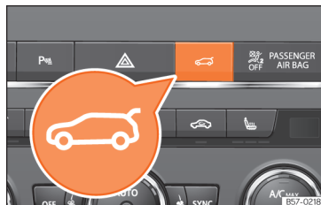
Obr. 58 Středová konzola: tlačítko pro otvírání a zavírání zadního víka.
