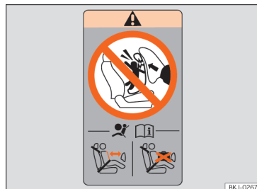
Obr. 35 Štítek airbagu: na horním rámu dveří spolujezdce.
