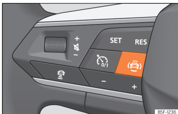
Obr. 104 Levá strana multifunkčního volantu: tlačítko asistenčních systémů řidiče (v závislosti na modelu).
