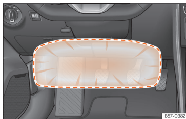
Obr. 35 Na straně řidiče: oblast působnosti kolenního airbagu.
