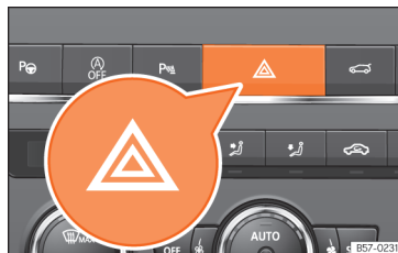
Obr. 44 Přístrojová deska: spínač výstražných světel.
