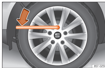
Obr. 223 Výměna kola: Povolení šroubů kola
