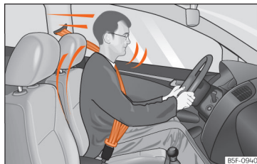
Obr. 19 Řidiči se správně připnutými pásy nebudou při náhlém brzdění vymrštěni dopředu.
