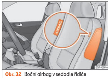
Obr. 32 Boční airbag v sedadle řidiče
