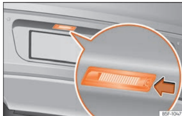
Obr. 121 Zadní nárazník: Osvětlení státní poznávací značky.
