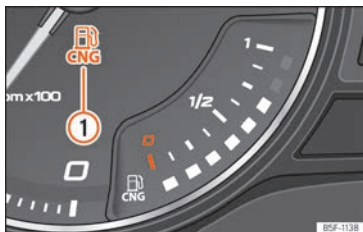
Obr. 133 Analogový panel přístrojů: ukazatel zásoby zemního plynu
