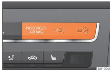
Obr. 29 Přístrojová deska: kontrolka deaktivovaného airbagu spolujezdce.
