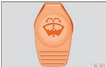
Obr. 66 V motorovém prostoru: uzávěr nádržky kapaliny do ostřikovačů.
