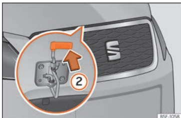
Obr. 13 Páčka pod víkem motorového prostoru.
