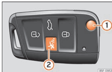
Obr. 141 Klíč od vozidla s tlačítkem alarmu.
