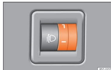
Obr. 153 Vedle volantu: Ovladač regulace sklonu světlometů.
