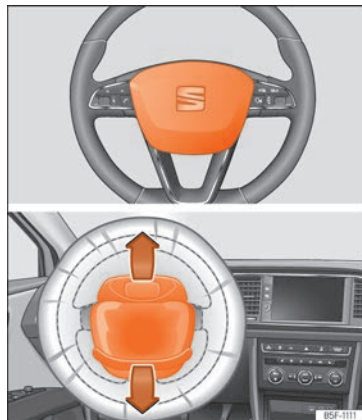
Obr. 26 Místo montáže airbagu řidiče: ve volantu.
