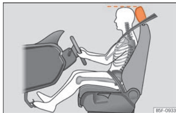
Obr. 88 Správné nastavení opěrky hlavy řidiče.
