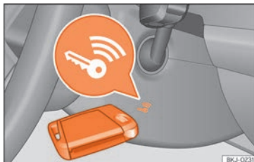
Obr. 253 Vpravo na sloupku řízení: Nouzový start.
