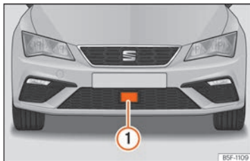
Obr. 271 V předním nárazníku: radarový snímač.
