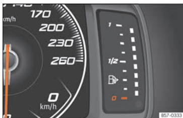
Obr. 132 Volně konfigurovatelný panel přístrojů: ukazatel zásoby paliva.
