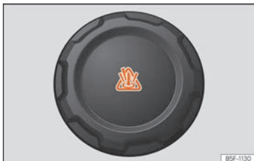
Obr. 64 Motorový prostor: uzávěr vyrovnávací nádrčky chladicí kapaliny motoru
