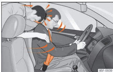
Obr. 95 Nepřipoutaný cestující na zadním sedadle je vymrštěn dopředu na připoutaného řidiče.
