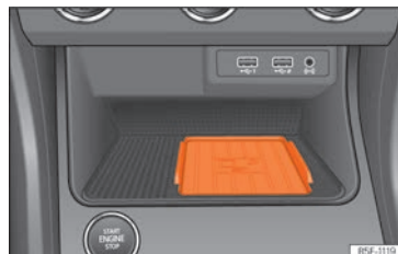
Obr. 250 Ve středové konzole: Úchyt pro spojení mobilního telefonu.
