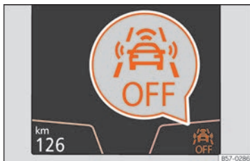
Obr. 267 Na displeji panelu přístrojů: informace o vypnutí systému Front Assist.
