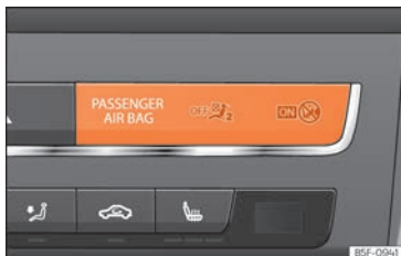
Obr. 99 Přístrojová deska: kontrolka deaktivovaného airbagu spolujezdce.
