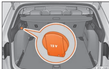
Obr. 170 Detail u bočního vnitřního obložení zavazadlového prostoru: 12 V zásuvka (platí pouze pro model LEON ST).
