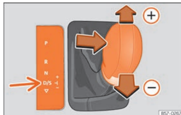
Obr. 259 Středová konzole: změna na Tiptronic.
