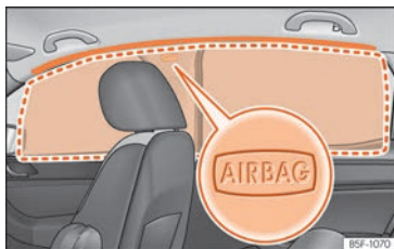
Obr. 34 Místo montáže hlavového airbagu
