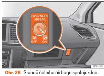
Obr. 28 Spínač čelního airbagu spolujezdce.
