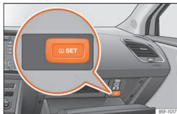
Obr. 316 Odkládací přihrádka: Spínač ukazuje kontrolu pneumatik.
