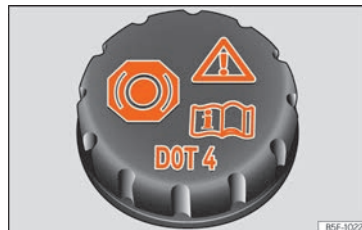
Obr. 65 Motorový prostor: uzávěr nádrčky brzdové kapaliny
