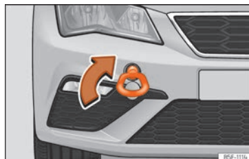
Obr. 101 Přední nárazník vpravo: zašroubované vlečné oko
