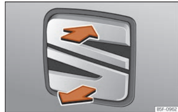
Obr. 8 Zadní víko: otevření zvenku
