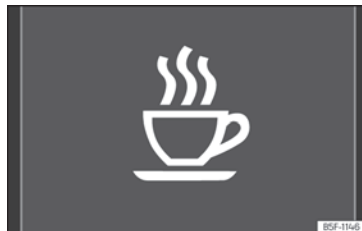
Obř. 129 Na displeji panelu přístrojů: Symbol rozpoznání únavy.
