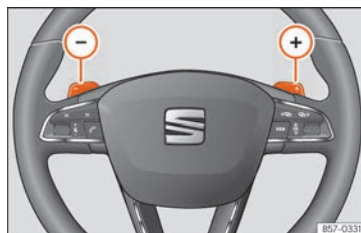
Obr. 260 Volant: páčky pro automatickou převodovku.
