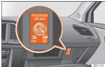
Obr. 98 Spínací klíč pro vypnutí a zapnutí airbagu spolujezdce.
