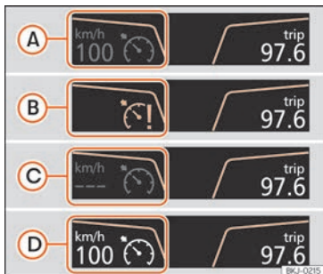
Obr. 264 Displej panelu přístrojů: ukazatele stavu tempomatu.
