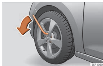
Obr. 77 Kolo: povolte šrouby kol.
