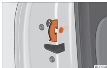
Obr. 140 Bezpečnostní dětská pojistka v levých dveřích
