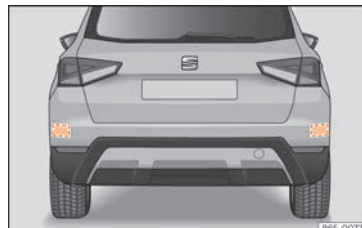
Obr. 243 Oblast za vozidlem: Oblasti radarových snímačů.
