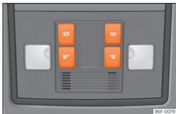
Obr. 44 Detail stropního panelu: Osvětlení interiéru vpředu.
