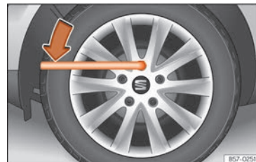
Obr. 72 Výměna kola: Povolení šroubů kol
