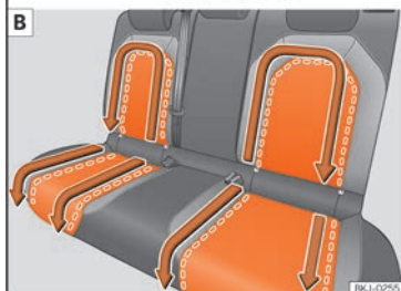
Obr. 152 Odmontujte snímatelné ochranné potahy. A Sedadlo vpředu vlevo; B Sedadla vzadu
