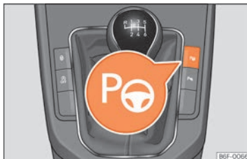
Obr. 248 Ve středové konzole: tlačítko pro zapnutí parkovacího asistenta.
