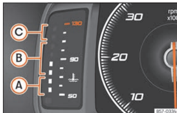
Obr. 125 Volně konfigurovatelný panel přístrojů: ukazatel teploty chladicí kapaliny motoru.
