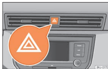
Obr. 43 Přístrojová deska: Spínač výstražných světel
