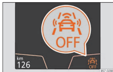
Obr. 232 Na displeji panelu přístrojů: informace o vypnutí systému Front Assist.
