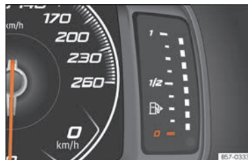
Obr. 122 Volně konfigurovatelný panel přístrojů: ukazatel zásoby paliva.
