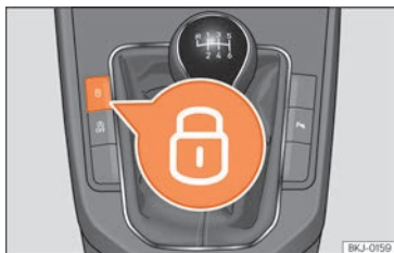
Obr. 135 Tlačítko centrálního zamykání
