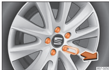
Obr. 71 Kolo: Šrouby kola s víkem.
