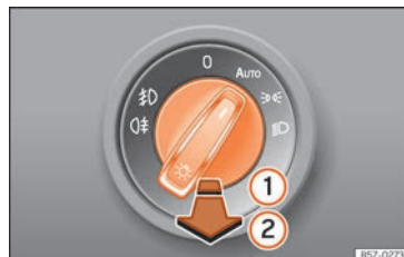
Obr. 142 Přístrojová deska: Ovládací prvek světel
