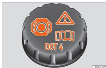
Obr. 61 Motorový prostor: uzávěr nádržky brzdové kapaliny
