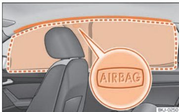
Obr. 28 Umístění a oblast nafouknutí hlavového airbagu.
