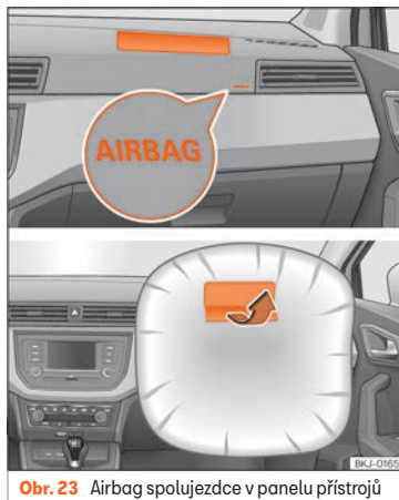
Obr. 23 Airbag spolujezdce v panelu přístrojů
