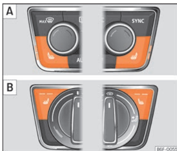
Obr. 150 Ve středové konzole: Ovladač vyhřívání předních sedadel. [A]: verze s Climatronic. [B]: verze s ruční klimatizací.
