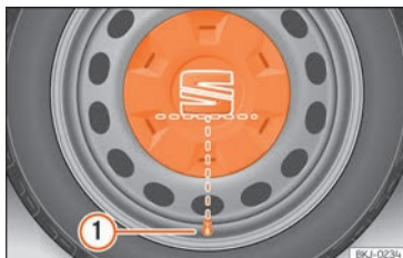
Obr. 70 Správné umístění celoplošného krytu kola u ocelových disků.
