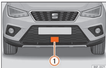
Obr. 231 V předním nárazníku: radarový snímač.
