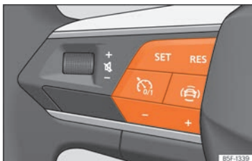
Obr. 100 Na multifunkčním volantu: tlačítka k ovládání tempomatu.
