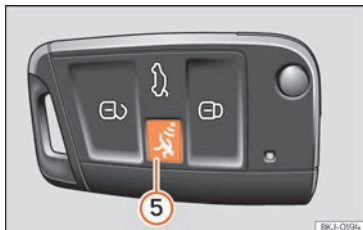
Obr. 46 Klíč vozidla s tlačítkem alarmu.
