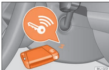
Obr. 84 Vpravo na sloupku řízení: nouzový start.
