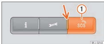
Obr. 44 Ve stropní konzole: spínač hlasových služeb.
