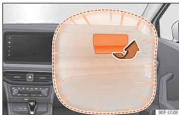
Obr. 28 Airbag spolujezdce v přístrojové desce
