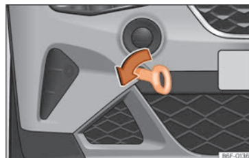
Obr. 166 Přední nárazník vpravo: zašroubované vlečné oko
