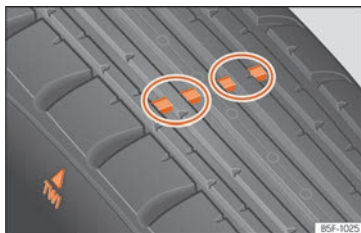
Obr. 191 Vzorek pneumatiky: ukazatele opotřebení.
