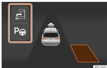
Obr. 126 Na displeji panelu přístrojů: zobrazení parkovacího asistenta s omezeným výhledem.
