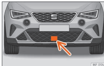
Obr. 94 V předním nárazníku: radarový snímač.
