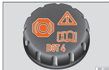
Obr. 183 Motorový prostor: uzávěr nádrčky brzdové kapaliny
