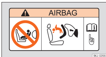
Obr. 35 Štítek airbagu: na sluneční cloně.
