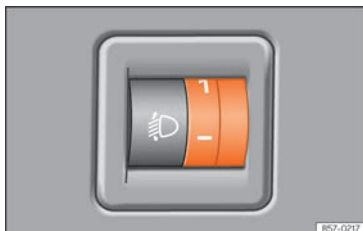
Obr. 72 Vedle volantu: ovladač regulace dosahu světel
