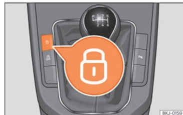
Obr. 52 Středová konzola: tlačítko centrálního zamykání.
