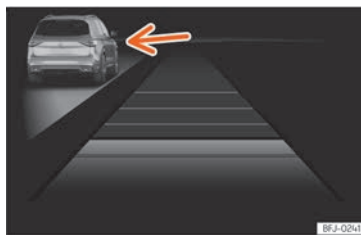
Obr. 105 Na displeji panelu přístrojů: aktivní ACC, rozpoznáno vozidlo na levé straně.
