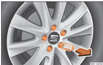
Obr. 195 Kolo: šrouby kola s víkem.
