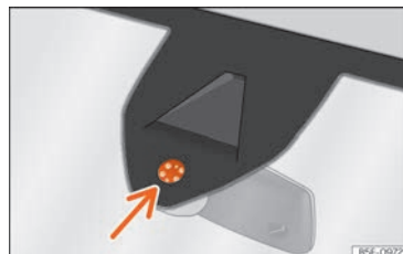
Obr. 76 Citlivá plocha snímače deště.
