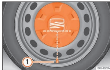
Obr. 194 Správné umístění celoplošného krytu kola u ocelových disků.
