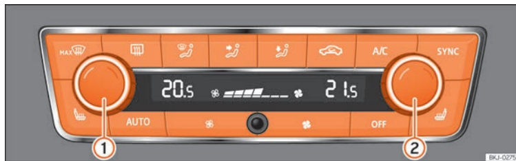
Obr. 80 Ve středové konzole: ovládací prvky pro Climatronic.
