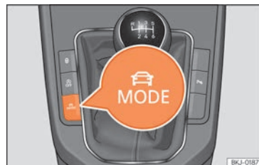
Obr. 91 Vedle řadicí páky: tlačítko MODE.
