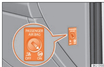
Obr. 29 Klíčem ovládaný spínač pro připojení a odpojení airbagu spolujezdce.
