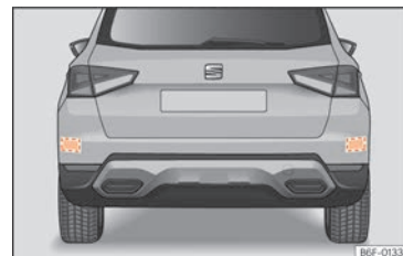
Obr. 97 Oblast za vozidlem: oblasti radarových snímačů.
