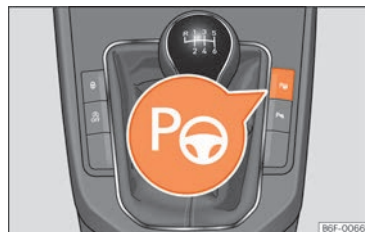
Obr. 125 Ve středové konzole: tlačítko pro zapnutí naváděcího parkovacího asistenta.
