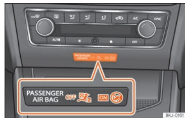
Obr. 30 Střední díl přístrojové desky: Kontrolka při odpojeném airbagu spolujezdce.
