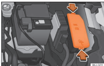
Obr. 170 V motorovém prostoru: kryt pojistkové skříňky.
