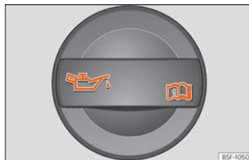
Obr. 188 Uzávěr plnicího otvoru motorového oleje v motorovém prostoru.
