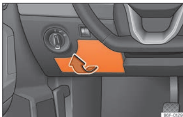
Obr. 169 Na straně řidiče v přístrojové desce: kryt pojistkové skříňky.
