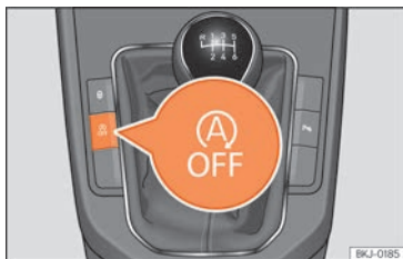
Obr. 85 Středová konzola: tlačítko systému start-stop.
