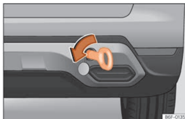
Obr. 168 Na pravé straně zadního nárazníku: zašroubované vlečné oko.
