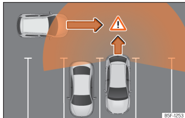
Obr. 164 Schematické vyobrazení asistenta vyparkování: sledovaná oblast vyjíždějícího vozidla.
