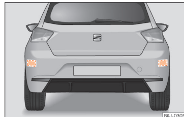
Obr. 145 Pohled na zad' vozidla: oblasti radarových snímačů.
