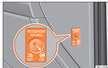
Obr. 16 Klíčem ovládaný spínač pro připojení a odpojení airbagu spolujezdce.
