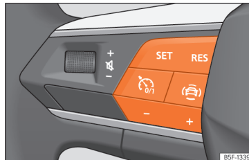
Obr. 149 Na multifunkčním volantu: tlačítka k ovládání omezovače rychlosti
