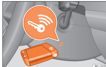
Obr. 134 Vpravo na sloupku řízení: Nouzový start.
