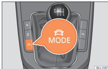
Obr. 141 Vedle řadič páky: tlačítko MODE.
