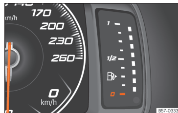
Obr. 67 Vlně konfigurovatelný panel přístrojů: palivoměr
