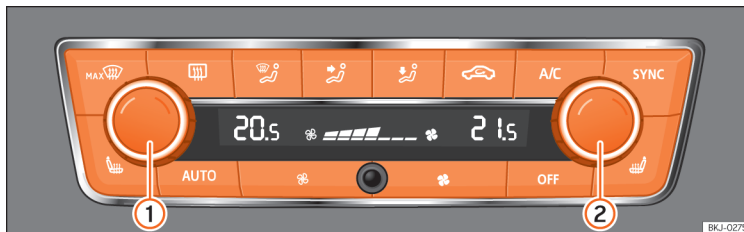
Obr. 122 Ve středové konzole: ovládací prvky Climatronic.
