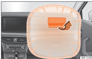
Obr. 15 Airbag spolujezdce v panelu přístrojů
