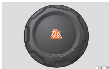
Obr. 193 Motorový prostor: uzávěr vyrovnávací nádobky chladicí kapaliny motoru.
