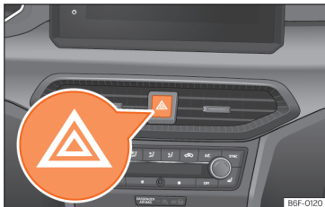
Obr. 98 Přístrojová deska: spínač výstražných světel.
