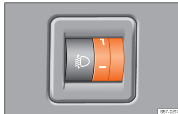
Obr. 99 Vedle volantu: Ovladač regulace dosahu světel.
