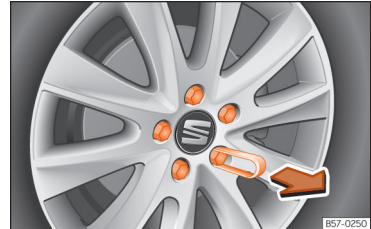
Obr. 34 Kolo: Šrouby kola s víkem.
