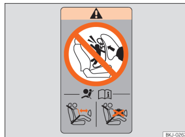
Obr. 23 Nálepka pro airbag: v zadní části rámu dveří spolujezdce
