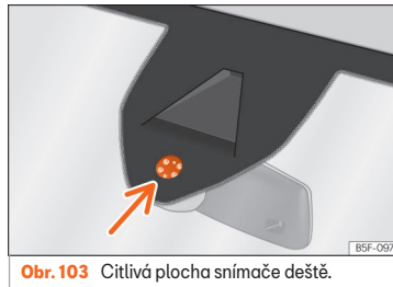
Obr. 103 Citlivá plocha snímače deště.
