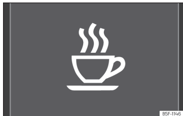
Obr. 63 Na displeji panelu přístrojů: symbol rozpoznání únavy.
