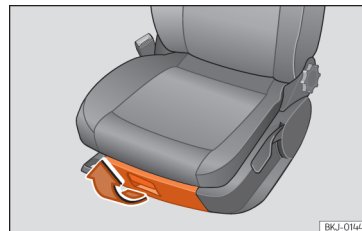
Obr. 118 Odkládací přihrádka pod pravým předním sedadlem.
