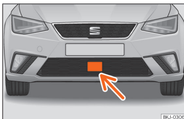
Obr. 142 Na předním nárazníku: radarový snímač.
