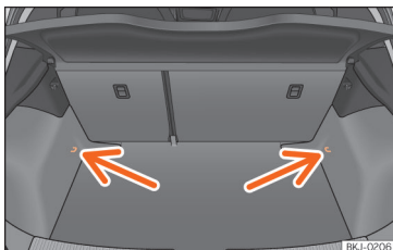
Obr. 115 Uspořádání uvazovacích ok v zavazadlovém prostoru.
