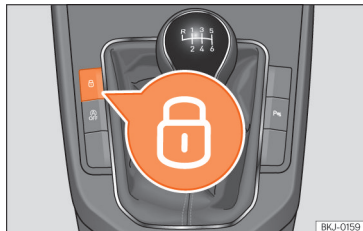
Obr. 83 Středová konzola: spínač centrálního zamykání
