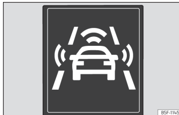
Obr. 150 Na displeji panelu přístrojů: signalizace předběžné výstrahy.
