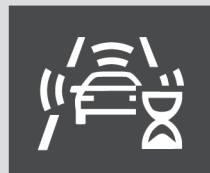
Obr. 151 Na displeji panelu přístrojů: signalizace první automatické kalibrace systému.
