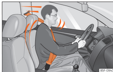
Obr. 7 Řidiči se správně připnutými pásy nebudou při náhlém brzdění vymršteni dopředu.
