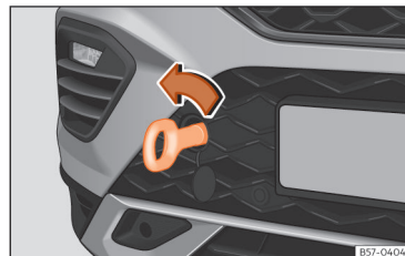
Obr. 196 Přední nárazník vpravo: zašroubované vlečné oko
