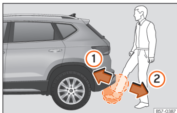
Obr. 59 Zadní víko se snímači řízeným otvíráním a zavíráním (Easy Open).
