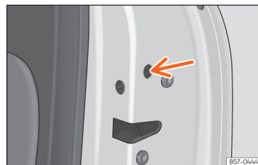
Obr. 54 Nouzová uzávěra dveří.
