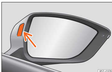
Obr. 128 Kontrolka asistenta změny jízdního pruhu.
