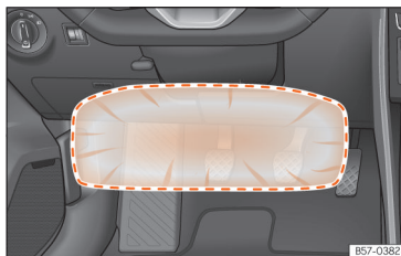
Obr. 32 Na straně řidiče: oblast působnosti kolenního airbagu.
