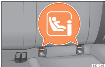
Obr. 36 Zadní sedadlo: Montážní místo přídržných ok pro ISOFIX nebo i-Size.
