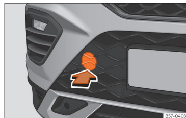
Obr. 195 Na pravé straně předního nárazníku: odstranění krytu.
