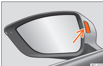
Obr. 127 Kontrolka asistenta změny jízdního pruhu.
