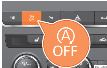
Obr. 96 Středová konzola: tlačítko systému start-stop.
