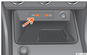
Obr. 158 Středová konzola: vstup USB.
