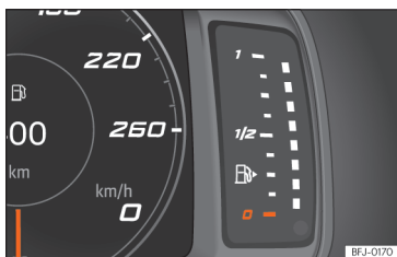
Obr. 4 Sdružené přístroje SEAT Digital Cockpit: Palivoměr.
