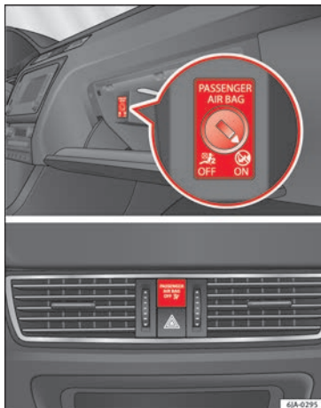
Obr. 81 Spínač čelního airbagu spolujezdce/kontrolka pro vypnutí airbagu spolujezdce
