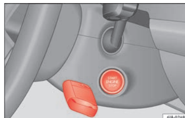
Obr. 173 Nouzové nastartování u vozidel s Keyless Access
