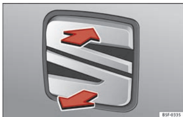
Obr. 125 Zadní výklopné dveře: otevření zvenku
