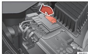
Obr. 210 Akumulátor: otevření krytu
