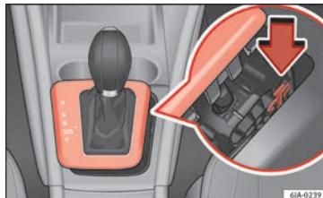
Obr. 44 Nouzové odemykání zámku volicí páky
