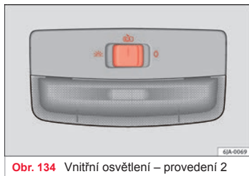
Obr. 134 Vnitřní osvětlení – provedení 2
