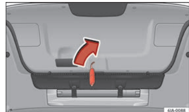
Obr. 6 Detail zavazadlového prostoru: přístup k nouzovému odemykání
