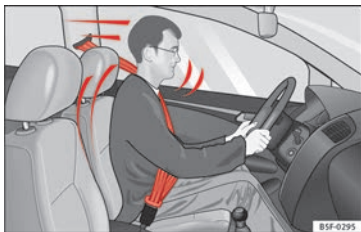
Obr. 75 Řidiči se správně připnutými pásy nebudou při náhlém brzdění vymrštěni dopředu.
