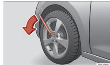
Obr. 62 Výměna kola: povolení šroubů kol
