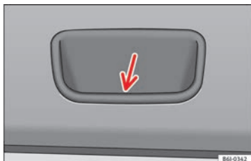
Obr. 126 Detail vnitřního obložení víka zavazadlového prostoru: zapuštěné madlo pro zavírání zavazadlového prostoru
