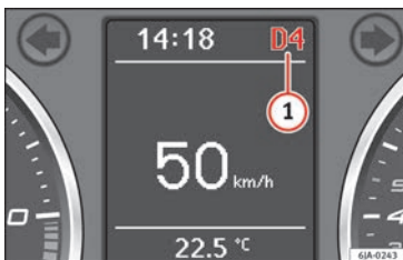
Obr. 177 Informační displej: polohy volič páky
