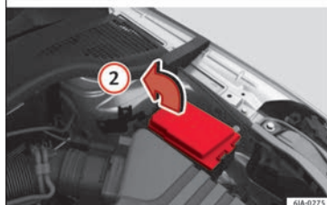
Obr. 87 V motorovém prostoru: kryt skříňe pojistek - varianta 2
