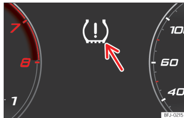
Obr. 228 Sdružené přístroje: výstraha pro ztrátu tlaku v pneumatice.
