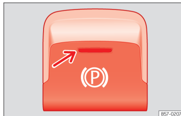
Obr. 131 Ve spodní oblasti středové konzoly: tlačítko elektronické parkovací brzdy.
