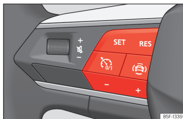
Obr. 111 Na multifunkčním volantu: tlačítka k ovládání tempomatu.
