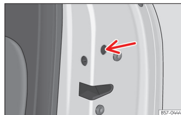
Obr. 54 Nouzové zamknutí dveří.
