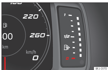
Obr. 4 Sdružené přístroje SEAT Digital Cockpit: Palivoměr.
