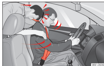
Obr. 19 Nepřipoutaný spolujezdec na zadním sedadle je vymrštěn směrem dopředu na připoutaného řidiče.
