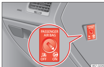
Obr. 26 Klíčem ovládaný spínač pro připojení a odpojení airbagu spolujezdce.
