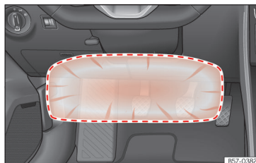
Obr. 32 Na straně řidiče: oblast působnosti kolenního airbagu.
