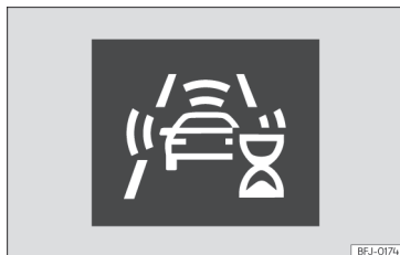
Obr. 122 Na displeji sdružených přístrojů: signalizace první automatické kalibrace systému.
