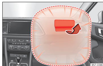
Obr. 25 Airbag spolujezdce v přístrojové desce.
