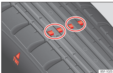
Obr. 218 Vzorek pneumatiky: ukazatele opotřebení.
