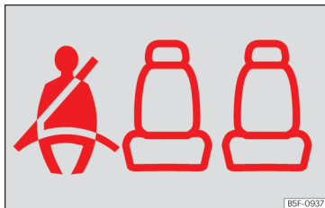
Obr. 17 Sdružené přístroje: signalizace stavu bezpečnostních pásů pro zadní sedadla.
