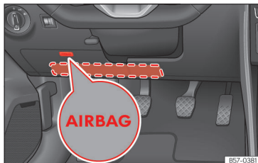
Obr. 31 Na straně řidiče: montážní místo kolenního airbagu.
