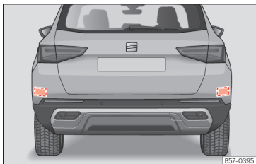
Obr. 108 Oblast za vozidlem: oblasti radarových snímačů.
