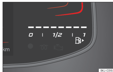
Obr. 3 Sdružené přístroje Basic: Palivoměr.
