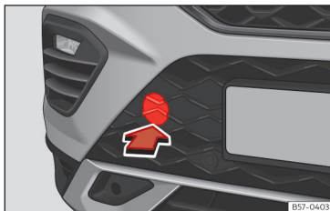
Obr. 196 Na pravé straně předního nárazníku: odstranění krytu.
