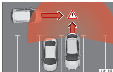
Obr. 151 Schematické vyobrazení asistenta vyparkování: sledovaná oblast vyjíždějícího vozidla.
