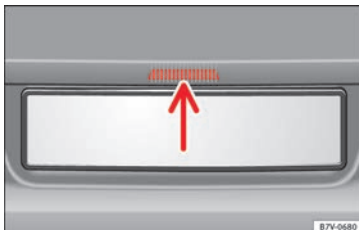
Obr. 7 Otevírání zadních výklopných dveří zvenčí
