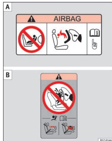
Obr. 35 Samolepka airbagu - verze 2: na sluneční cloně spolujezdce [A] a na zadním rámu dveří spolujezdce [B].
