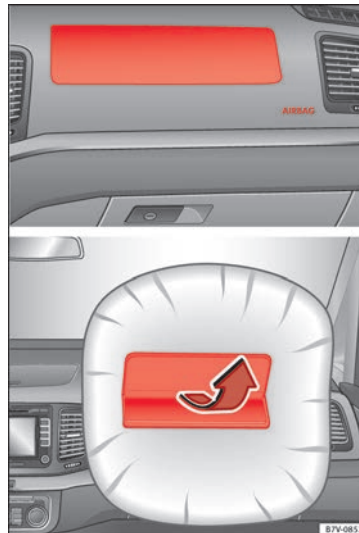
Obr. 26 Montážní poloha a oblast účinnosti čelního airbagu spolujezdce
