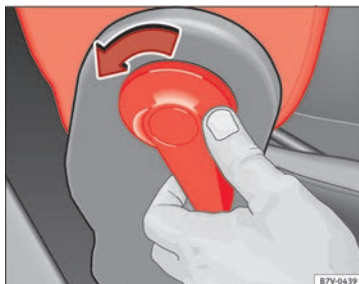
Obr. 160 Odjistění sklápěcího opěradla sedadla spolujezdce
