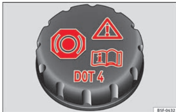
Obr. 246 V motorovém prostoru: uzávěr nádržky brzdové kapaliny
