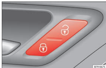
Obr. 130 U dveří řidiče: tlačítko centrálního zamykání dveří.
