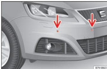
Obr. 209 Snímače kontroly vzdálenosti při parkování vpředu v nárazníku
