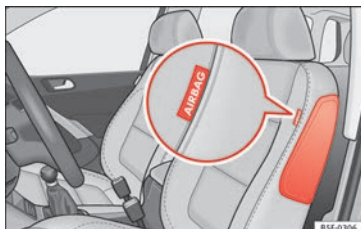
Obr. 30 Na straně předního sedadla: umístění bočního airbagu.
