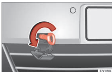
Obr. 103 Přední nárazník vpravo: našroubování vlečného oka.
