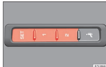
Obr. 157 Paměťová tlačítka na vnější straně sedadla řidiče
