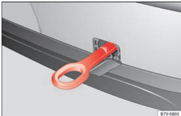
Obr. 73 Zadní nárazník vpravo: zašroubované vlečné oko.
