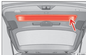
Obr. 137 Otevřené zadní výklopné dveře (zadní víko): zapuštěné madlo pro zavírání zavazadlového prostoru
