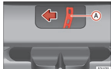
Obr. 9 Ze zavazadlového prostoru: nouzově odemkněte zadní výklopné dveře (zadní víko).
