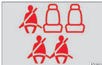
Obr. 83 Příklad pro zobrazení stavu bezpečnostního pásu na zadních sedadlech (zde u 7místné verze) v panelu přístrojů: nahore druhá řada sedadel, dole třetí řada sedadel.
