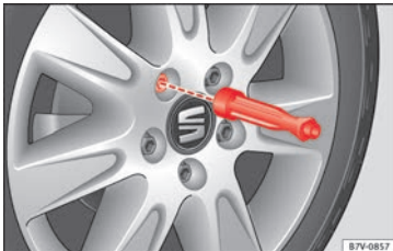
Obr. 71 Výměna kola: našroubování šroubů kol rukojetí šroubováku.
