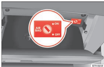
Obr. 92 V odkládací přihrádce na straně spolujezdce: klíčový přepínač k vypnutí a zapnutí čelního airbagu na straně spolujezdce.
