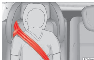
Obr. 96 Integrovaná dětská sedačka: průběh pásu s vodící třmenem
