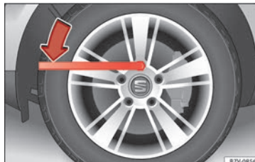
Obr. 67 Výměna kola: povolte šrouby kol.
