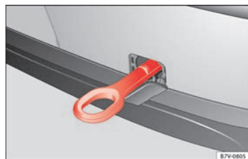
Obr. 104 Zadní nárazník vpravo: zašroubované vlečné oko.
