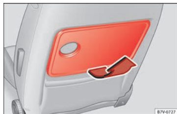
Obr. 185 Na předním sedadle: sklopný stolek.
