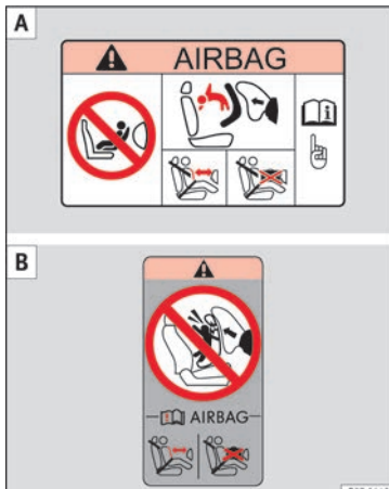
Obr. 34 Samolepka airbagu - verze 1: na sluneční cloně spolujezdce [A] a na zadním rámu dveří spolujezdce [B].
