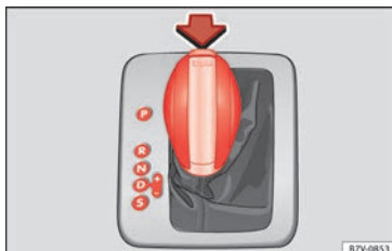
Obr. 48 Automatická převodovka: Polohy volicí páky.
