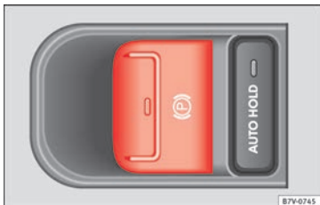
Obr. 201 Na středové konzole: spínač elektronické parkovací brzdy.
