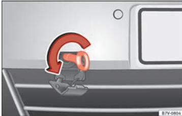
Obr. 72 Přední nárazník vpravo: našroubování vlečného oka.
