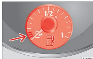
Obr. 234 Panel přístrojů: ukazatel zásoby benzínu nebo motorové nafty.
