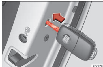
Obr. 5 Nouzové zamykání vozidla klíčem vozidla.
