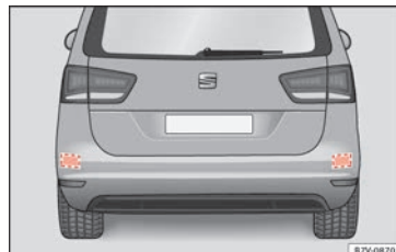
Obr. 221 Oblast za vozidlem: Oblasti radarových snímačů.
