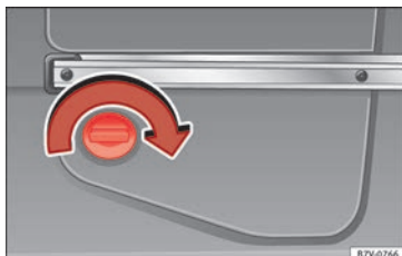
Obr. 236 V zadní části zavazadlového prostoru vlevo: nádržka pro AdBlue za krytem.
