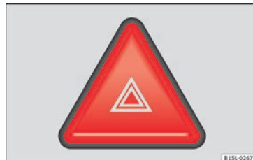
Obr. 140 Detail přístrojové desky: Spínač varovných světel
