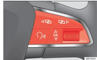
Obr. 45 Multifunkční volant: tlačítka k ovládání nabídek ve sdružených přístrojích
