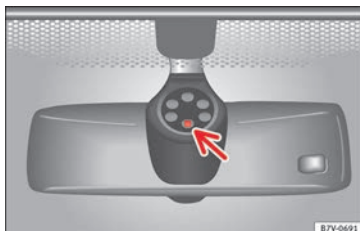
Obr. 145 Citlivá plocha dešťového snímače.
