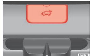
Obr. 8 Ze zavazadlového prostoru: Demontáž krytu zadních výklopných dveří.
