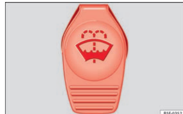
Obr. 247 V motorovém prostoru: uzávěr nádržky kapaliny do ostřikovačů.
