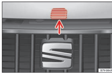
Obr. 11 Páčka pod víkem motorového prostoru.
