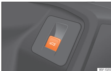
Obr. 3 Na dveřích řidiče: tlačítko pro otevírání a zavírání zadního víka.
