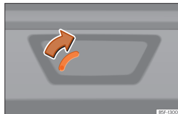
Obr. 5 Detail zavazadlového prostoru: nouzové odemknutí.
