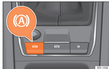
Obr. 150 Ve spodní oblasti středové konzoly: tlačítko funkce Auto Hold.
