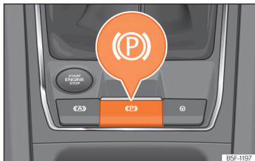
Obr. 149 Ve spodní oblasti středové konzoly: tlačítko elektronické parkovací brzdy.
