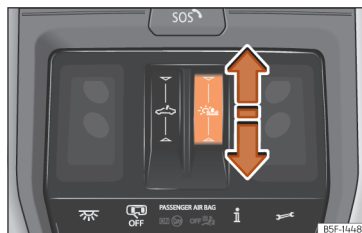
Obr. 88 Ve stropním panelu: ovládání protisluneční rolety.
