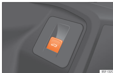
Obr. 81 Na dveřích řidiče: tlačítko pro otevírání a zavírání zadního víka.
