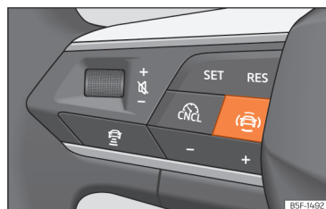
Obr. 124 Levá strana multifunkčního volantu: tlačítko asistenčních systémů řidiče (v závislosti na modelu).
