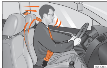
Obr. 17 Řidiči se správně připnutými pásy nebudou při náhlém brzdění vymrštěni dopředu.
