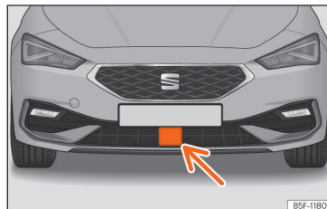
Obr. 125 V předním nárazníku: radarový snímač.
