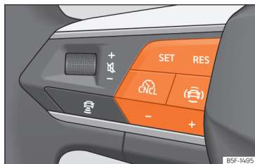
Obr. 131 Na multifunkčním volantu: tlačítka k ovládání tempomatu.
