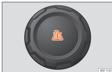
Obr. 223 Přední prostor: uzávěr vyrovnávací nádoby chladicí kapaliny.
