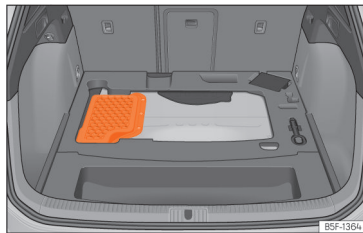
Obr. 231 Plug-in hybridní vozidla (PHEV): montážní místo akumulátoru v zavazadlovém prostoru
