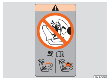
Obr. 38 Štítek airbagu: na horním rámu dveří spolujezdce.
