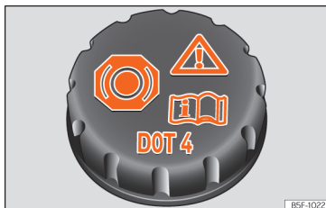
Obr. 224 Motorový prostor: uzávěr nádrčky brzdové kapaliny
