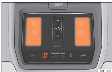
Obr. 105 Výřez stropního panelu: vnitřní osvětlení vpředu.
