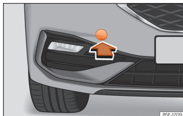
Obr. 212 Na pravé straně předního nárazníku: odstranění krytu.
