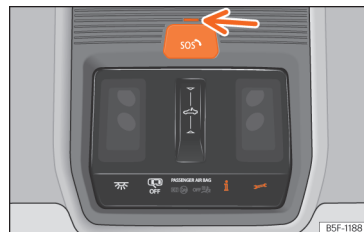
Obr. 48 Ve stropní konzole: spínač hlasových služeb.
