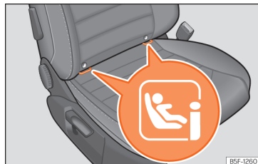
Obr. 40 Sedadlo spolujezdce: Montážní místo přídržných ok pro i-Size.
