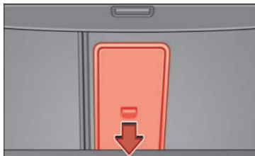
Obr. 172 V zavazadlovém prostoru: otvor průchozího úložného zařízení.
