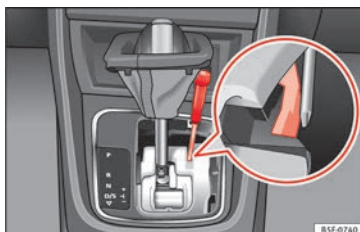
Obr. 55 Volicí páka: Nouzové odblokování z parkovací polohy.
