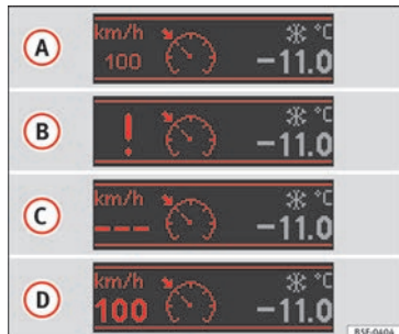
Obr. 193 Displej panelu přístrojů: ukazatele stavu tempomatu.
