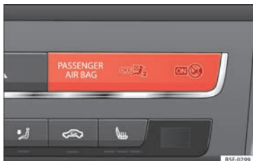
Obr. 96 Kontrolka deaktivace airbagu spolujezdce.
