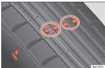
Obr. 239 Vzorek pneumatiky: ukazatele opotřebení.
