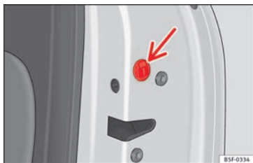
Obr. 4 Nouzové zablokování dveří.
