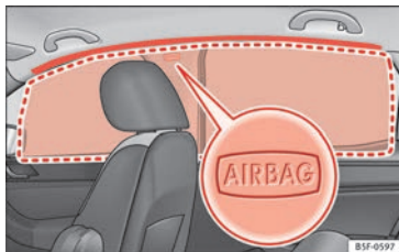
Obr. 28 Místo montáže hlavového airbagu
