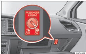
Obr. 95 Spínač čelního airbagu spolujezdce.
