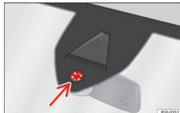
Obr. 145 Citlivá plocha dešťového snímače.
