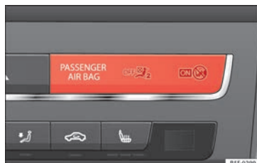
Obr. 52 Kontrolka deaktivace airbagu spolujezdce.
