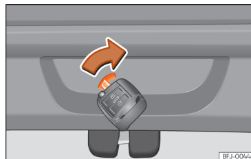
Obr. 79 Detail zavazadlového prostoru: nouzové odemknutí.
