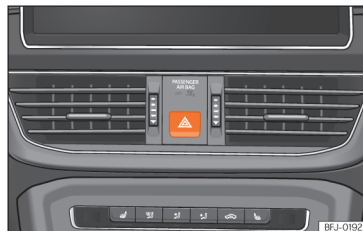
Obr. 49 Přístrojová deska: spínač výstražných světel.
