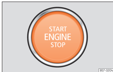
Obr. 118 Ve spodní oblasti středové konzoly: Startovací tlačítko.
