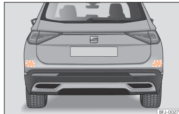
Obr. 134 Oblast za vozidlem: oblasti radarových snímačů.
