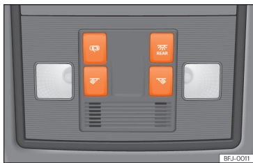
Obr. 106 Výřez stropního panelu: vnitřní osvětlení vpředu.
