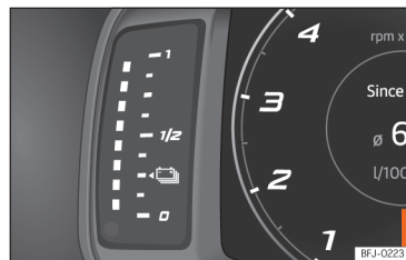
Obr. 8 Panel přístrojů: signalizace stavu nabití akumulátoru.
