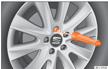
Obr. 256 Výměna kola: vyšroubujte šrouby kol rukojeti šroubováku.
