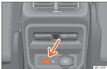
Obr. 185 Středová konzola vzadu: Přípojka USB s funkcí zásuvky.
