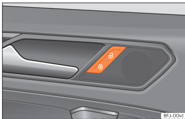
Obr. 70 Ve dveřích řidiče: tlačítko centrálního zamykání.
