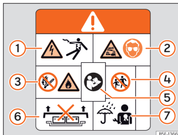
Obr. 52 Výstražná tabulka na vysokonapěťovém akumulátoru.
