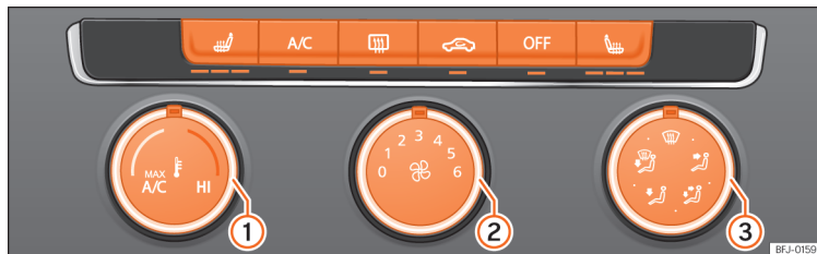
Obr. 113 Ve středové konzole: Ovládací prvky manuální klimatizace.
