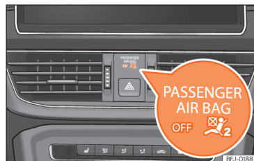
Obr. 33 Přístrojová deska: kontrolka deaktivovaného airbagu spolujezdce.
