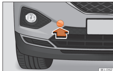
Obr. 224 Na pravé straně předního nárazníku: odstranění krytu.
