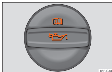
Obr. 242 Uzávěr plnicího otvoru motorového oleje v motorovém prostoru.
