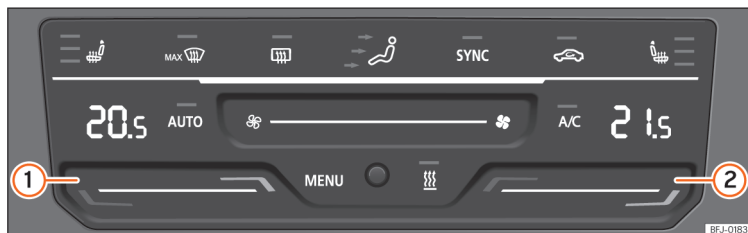
Obr. 112 Ve středové konzole: ovládací prvky pro Climatronic.
