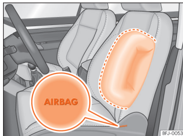
Obr. 34 Boční airbag v sedadle řidiče
