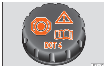
Obr. 237 Motorový prostor: uzávěr nádrčky brzdové kapaliny
