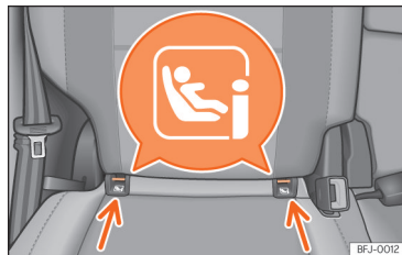
Obr. 41 Zadní sedadlo: Montážní místo přídržných ok pro ISOFIX nebo i-Size.
