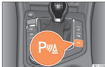
Obr. 158 Středová konzola: Tlačítko parkovacího asistenta (dle provedení).
