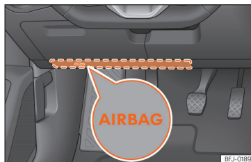
Obr. 36 Na straně řidiče: montážní místo kolenního airbagu.
