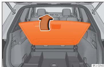
Obr. 198 V zavazadlovém prostoru: vyklopená podlaha zavazadlového prostoru.
