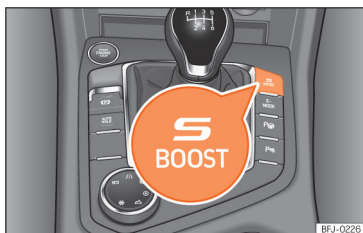
Obr. 128 Středová konzola: tlačítko S-BOOST
