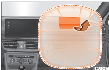
Obr. 31 Airbag spolujezdce v přístrojové desce.
