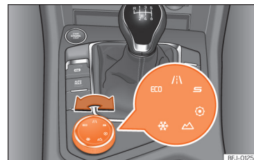
Obr. 127 Středová konzola: otočné tlačítko (Driving Experience button).
