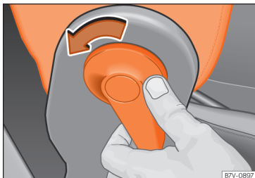
Obr. 90 Odjistění sklápěcího opěradla sedadla spolujezdce
