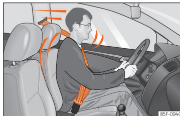
Obr. 11 Řidiči se správně připnutými pásy nebudou při náhlém brzdění vymršťováni dopředu.
