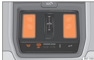
Obr. 105 Detail stropního panelu: osvětlení vnitřního prostoru vpředu.
