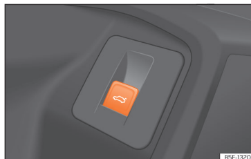
Obr. 95 U dveří řidiče: tlačítko pro otvírání a zavírání zadního víka.
