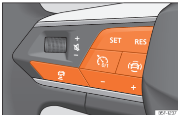
Obr. 180 Na multifunkčním volantu: tlačítka k ovládání systému ACC
