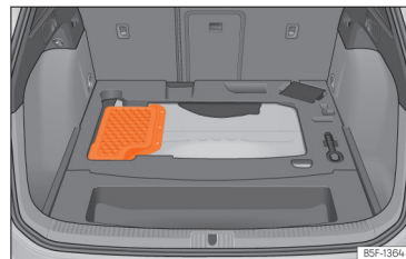
Obř. 237 Plug-in hybridní vozidla (PHEV): montážní místo akumulátoru v zavazadlovém prostoru
