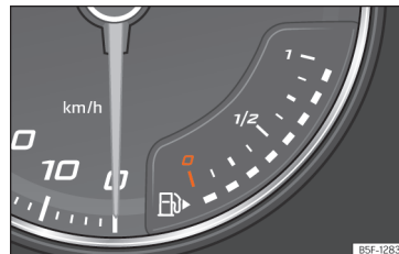
Obr. 67 Analogový panel přístrojů: palivoměr
