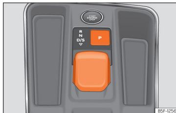
Obr. 167 Ve středové konzole: volicí páka.
