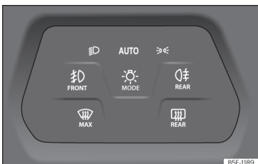
Obr. 102 Přístrojová deska: spínač světel.
