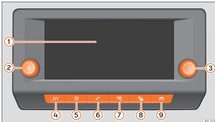
Obr. 155 Všeobecný přehled: ovládací prvky a zobrazení pro 8,25" provedení.
