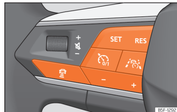
Obr. 188 Levá strana multifunkčního volantu: tlačítka k ovládání systému Travel Assist.
