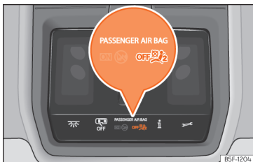
Obr. 21 Ve stropní konzole: kontrolka odpojení airbagu spolujezdce.
