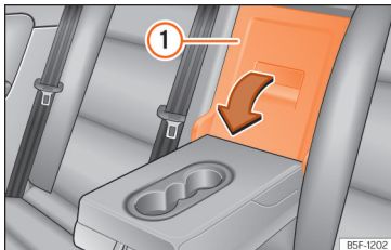
Obr. 137 Na opěradle zadního sedadla: otvor zařízení průchozího nakládání.
