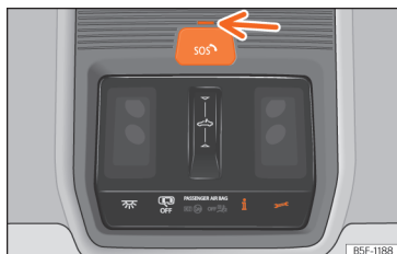
Obr. 37 Ve stropní konzole: spínač hovorových služeb
