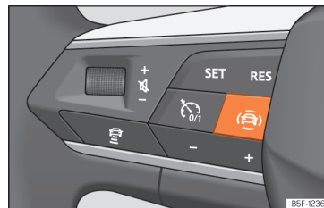
Obr. 73 Levá strana multifunkčního volantu: tlačítko asistenčních systémů řidiče (v závislosti na modelu).
