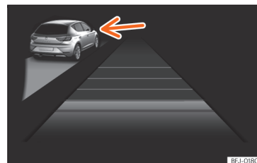
Obr. 182 Na displeji panelu přístrojů: aktivní ACC, rozpoznáno vozidlo na levé straně
