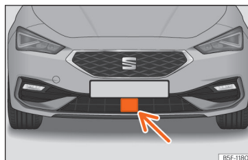
Obr. 169 Na předním nárazníku: radarový snímač.
