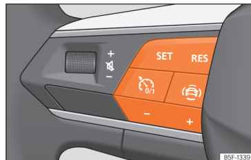
Obr. 176 Na multifunkčním volantu: tlačítka k ovládání omezovače rychlosti
