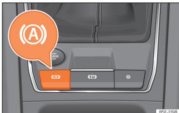
Obr. 197 Ve spodní části středové konzoly: tlačítko funkce Auto Hold.
