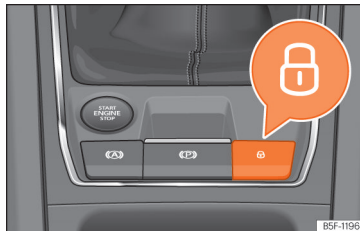
Obr. 87 Ve středové konzole: tlačítko centrálního zamykání dveří
