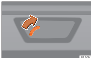
Obr. 98 Detail zavazadlového prostoru: nouzové odemknutí (Leon Sportstourer).
