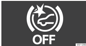
Obr. 179 Na displeji panelu přístrojů: signalizace vypnutí systému Front Assist.
