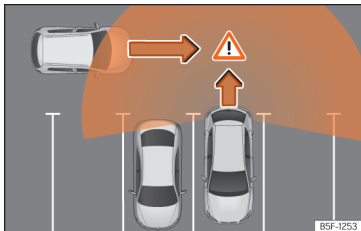
Obr. 193 Schematické vyobrazení asistenta vyparkování: sledovaná oblast vyjíždějícího vozidla.
