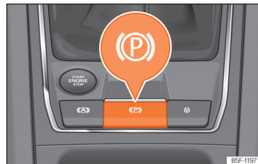
Obr. 196 Ve spodní části středové konzoly: tlačítko elektronické parkovací brzdy.
