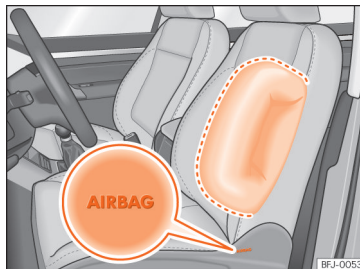
Obr. 26 Boční airbag v sedadle řidiče
