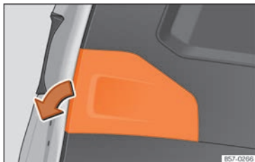
Obr. 205 Otevřené zadní víko: odstranění krytu.
