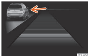
Obr. 119 Na displeji panelu přístrojů: aktivní ACC, rozpoznáno vozidlo na levé straně.
