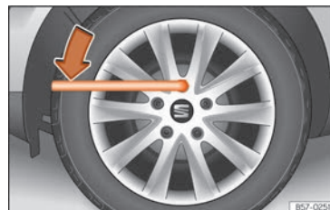
Obr. 226 Výměna kola: povolení šroubů kola
