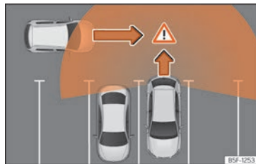
Obr. 154 Schematické vyobrazení asistenta vyparkování: sledovaná oblast vyjíždějícího vozidla.
