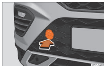
Obr. 197 Na pravé straně předního nárazníku: odstranění krytu.
