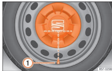
Obr. 223 Správné umístění celoplošného krytu kola u ocelových disků.
