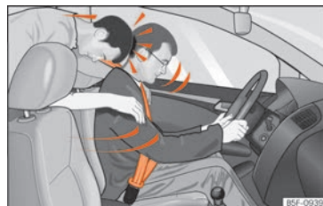
Obr. 22 Nepřipoutaný spolujezdec na zadním sedadle je vymrštěn směrem dopředu na připoutaného řidiče.
