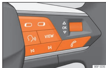
Obr. 12 Pravá strana multifunkčního volantu: ovládací prvky pro menu a zobrazení informací v panelu přístrojů (závisí na modelu).
