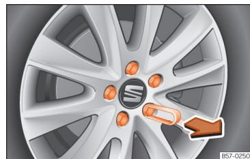
Obr. 186 Kolo: šrouby kola s víkem.
