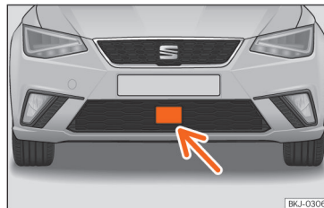
Obr. 94 V předním nárazníku: radarový snímač.
