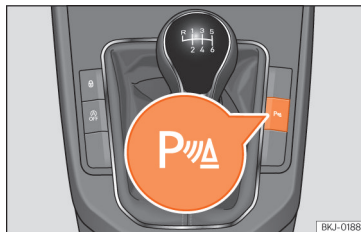
Obr. 121 Středová konzola: Tlačítko parkovacího asistenta (dle provedení).
