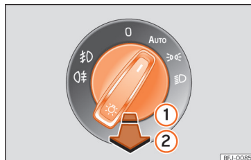
Obr. 70 Přístrojová deska: ovládací prvek světel
