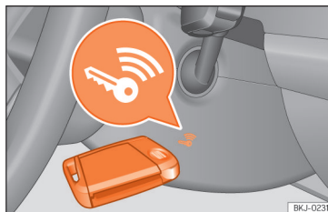
Obr. 84 Vpravo na sloupku řízení: nouzový start.
