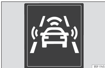
Obr. 110 Na displeji sdružených přístrojů: upozornění předběžné výstrahy.
