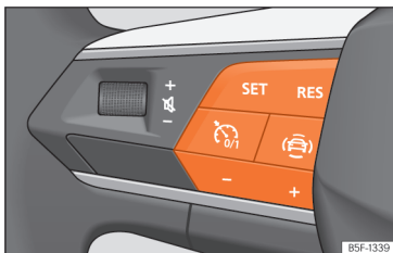
Obr. 100 Na multifunkčním volantu: tlačítka k ovládání tempomatu.
