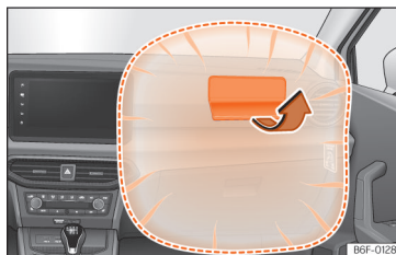
Obr. 26 Airbag spolujezdce v přístrojové desce
