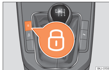
Obr. 50 Středová konzola: tlačítko centrálního zamykání.
