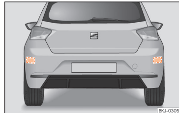
Obr. 97 Oblast za vozidlem: oblasti radarových snímačů.
