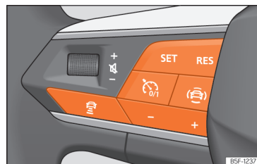
Obr. 104 Na multifunkčním volantu: tlačítka k ovládání systému ACC.
