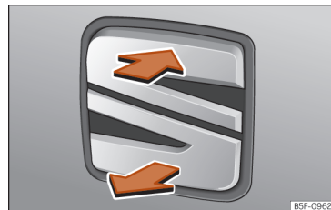
Obr. 55 Zadní víko: otvírání zvenku
