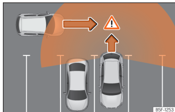
Obr. 124 Schematické vyobrazení asistenta vyparkování: sledovaná oblast vyjíždějícího vozidla.
