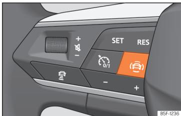
Obr. 93 Levá strana multifunkčního volantu: tlačítko asistenčních systémů řidiče [v závislosti na modelu].
