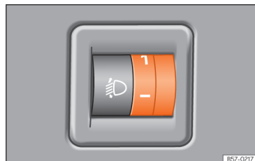
Obr. 72 Vedle volantu: ovladač regulace dosahu světel
