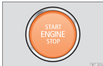
Obr. 83 Ve spodní oblasti středové konzoly: startovací tlačítko.
