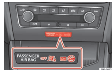
Obr. 47 Kontrolka deaktivace airbagu spolujezdce.
