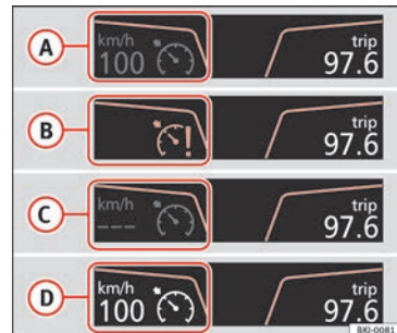
Obr. 153 Displej panelu přístrojů: ukazatele stavu tempomatu.
