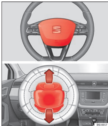
Obr. 17 Místo montáže airbagu řidiče: ve volantu.
