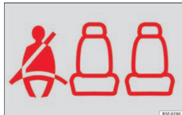
Obr. 82 Panel přístrojů: Zobrazení, že místo vzadu vpravo je obsazeno a příslušný bezpečnostní pás je připnut.
