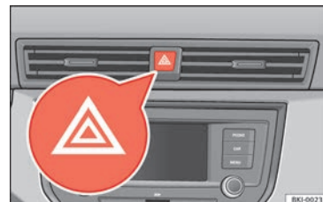
Obr. 34 Přístrojová deska: Spínač varovných světel
