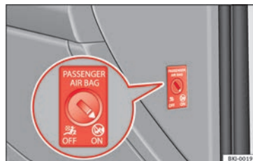
Obr. 88 Spínací klíč pro vypnutí a zapnutí airbagu spolujezdce.
