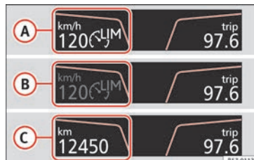
Obr. 154 Na displeji panelu přístrojů: zobrazení stavu omezovače rychlosti.
