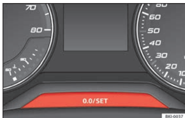
Obr. 107 Panel přístrojů: Počítadlo kilometrů a nulovací tlačítko.
