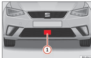
Obr. 164 V předním nárazníku: radarový snímač.
