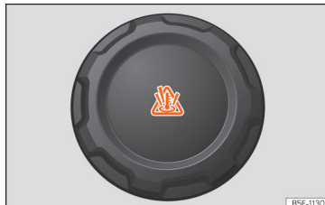
Obr. 198 Motorový prostor: uzávěr vyrovnávací nádobky chladicí kapaliny motoru.
