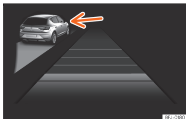
Obr. 151 Na displeji panelu přístrojů: aktivní ACC, rozpoznáno vozidlo na levé straně
