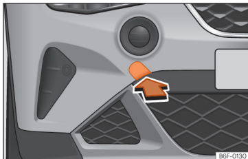
Obr. 44 Přední nárazník vpravo: odstranění krytu.
