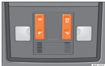
Obr. 97 Detail stropního panelu: osvětlení vnitřního prostoru vpředu.
