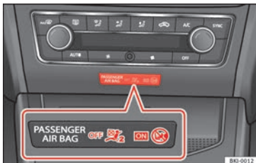
Obr. 23 Střední díl přístrojové desky: Kontrolka při odpojení airbagu spolujezdce.
