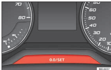
Obr. 126 Panel přístrojů: Počítadlo kilometrů a nulovací tlačítko.
