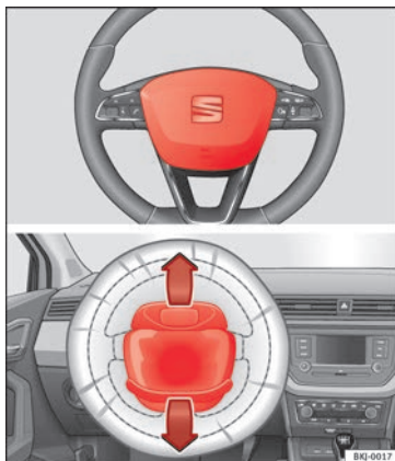
Obr. 20 Místo montáže airbagu řidiče: ve volantu.
