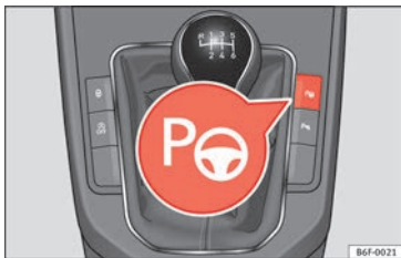
Obr. 209 Ve středové konzole: tlačítko pro zapnutí parkovacího asistenta.
