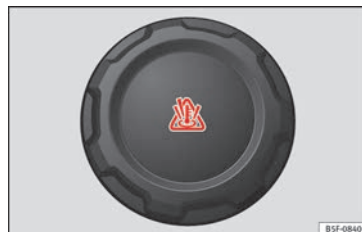
Obr. 67 Motorový prostor: uzávěr vyrovnávací nádržky chladicí kapaliny motoru
