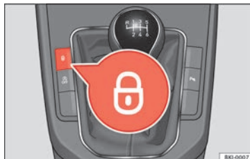
Obr. 3 Středová konzole: tlačítko centrálního zamykání dveří.
