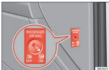
Obr. 103 Spínací klíč pro vypnutí a zapnutí airbagu spolujezdce.
