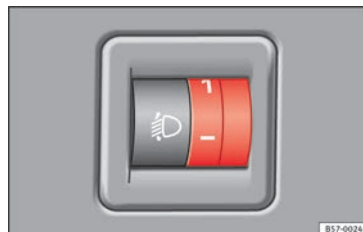
Obr. 148 Přístrojová deska: Ovladač nastavení sklonu světlometů.
