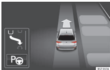
Obr. 211 Na displeji panelu přístrojů: Zobrazení parkovacího asistenta s omezenou viditelností.
