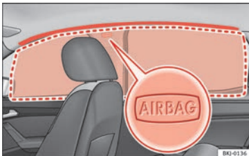
Obr. 26 Umístění a oblast nafouknutí hlavového airbagu.
