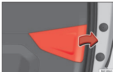
Obr. 118 Otevřené zadní výklopné dveře: odstraňte kryt.
