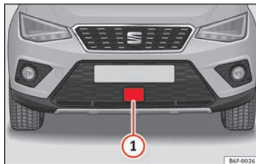
Obr. 190 V předním nárazníku: radarový senzor.
