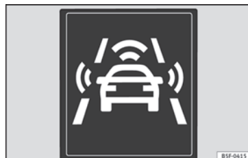
Obr. 189 Na displeji panelu přístrojů: pokyny předběžné výstrahy.
