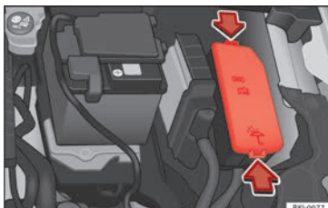
Obr. 71 V motorovém prostoru: kryt pojistkové skříňky.
