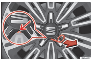
Obr. 78 Stáhnutí celoplošného krytu kola
