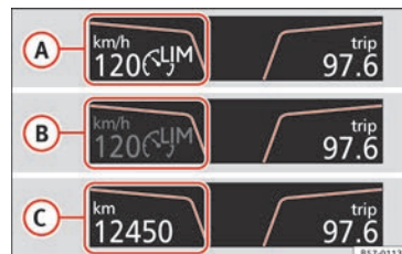
Obr. 186 Na displeji panelu přístrojů: zobrazení stavu omezovače rychlosti.
