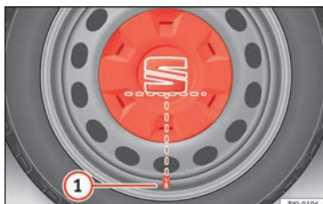
Obr. 77 Správné umístění celoplošného krytu kola u ocelových disků.
