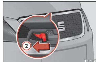
Obr. 10 Páčka pod víkem motorového prostoru.
