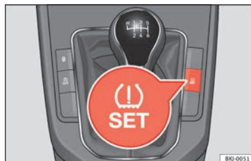
Obr. 242 Středová konzole: Tlačítko ukazatele kontroly tlaku vzduchu v pneumatikách
