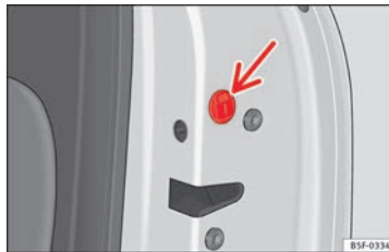
Obr. 5 Nouzové zablokování dveří.
