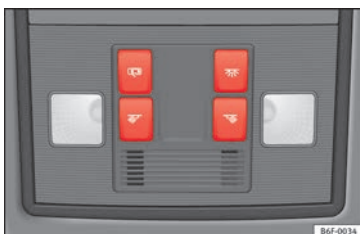
Obr. 42 Detail stropního panelu: Osvětlení interiéru vpředu.
